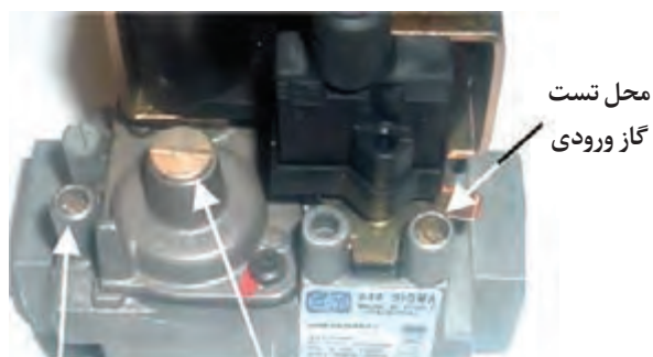
در زیر این دریوش پیچ تنظیم فشار گاز تزریقی است محل تست فشار گاز تزریقی
