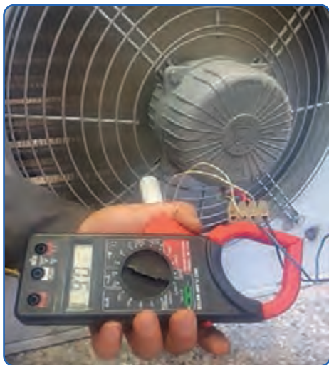
شکل ۱۶- اندازه گیری میزان شدت جریان (آمپر) موتور یونیت هیتر
