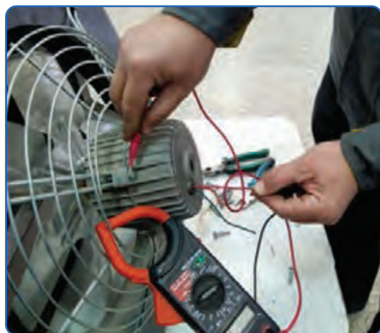
شکل ۲۰- اندازه گیری مقاومت اهمی موتور یونیت هیتر
