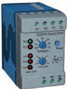
رله کنترل بار جایگزین مناسبی برای بی‌متال‌های حرارتی، به منظور محافظت از موتور در برابر اضافه جریان (اضافه بار) است. در این رله‌ها، با استفاده از یک سری کانال عبوری که سیم‌های سه فاز در داخل آنها قرار می‌گیرد، میزان جریان عبوری را توسط روش القایی اندازه می‌گیرند (مانند آمپر مترهای انبری). کاربرد عمده این رله‌ها در حفاظت موتورها، عبارت است از اضافه بار بیش از حد مجاز، دو فاز شدن، اتصالی در هر نقطه از مسیر جریان مصرفی (حتی در داخل موتور) و اختلالات داخلی موتور.
