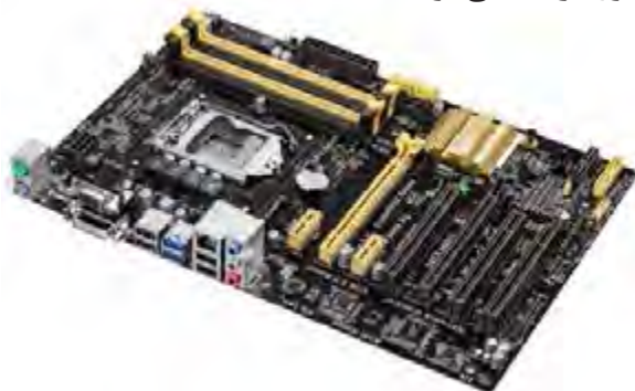
شکل ۸ - برد اصلی با فرم فاکتور ATX
