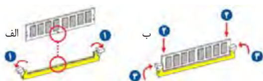
شکل ۴۰- مراحل نصب ماژول حافظه
