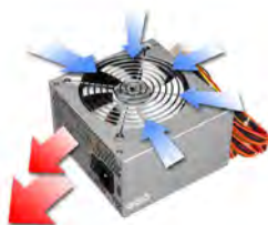
شکل ۲۳- جهت تهویه هوا در منبع تغذیه
