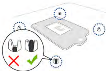
شکل ۳۸- پایه‌های سیستم خنک‌کننده در پشت برد اصلی
