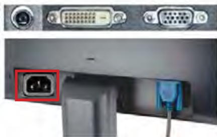
شکل ۴- محل اتصال کابل‌های صفحه نمایش
