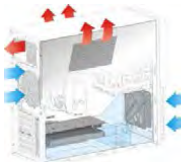
شکل ۳- تهویه کیس به وسیله فن‌ها
