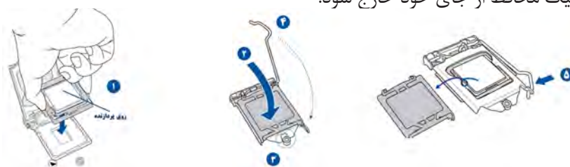
شکل ۳۵- مراحل قراردادن پردازنده در سوکت
