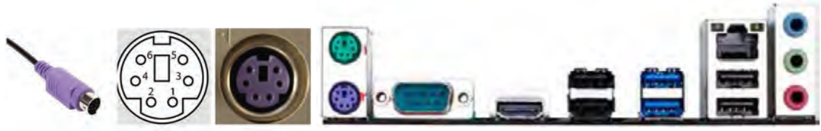
شکل ۸- درگاه‌های روی برد اصلی
