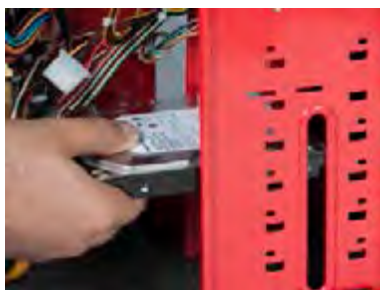
شکل ۴۸- محل نصب دیسک سخت
