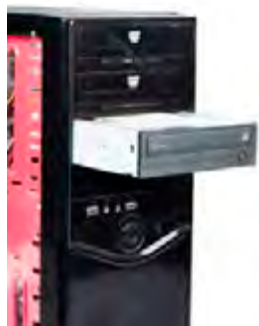
شکل ۵۰- قراردادن دیسک گردان نوری در کیس
