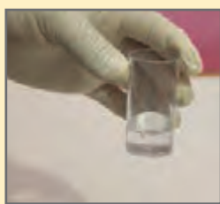
پرکردن آب تاخط نشانه
