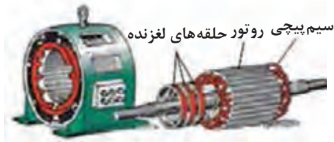
شکل ۴ - الکترو موتور با روتور سیم‌پیچی
