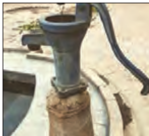
شکل ۲- تلمبه آب (سیلندر بیستونی قدیمی)
