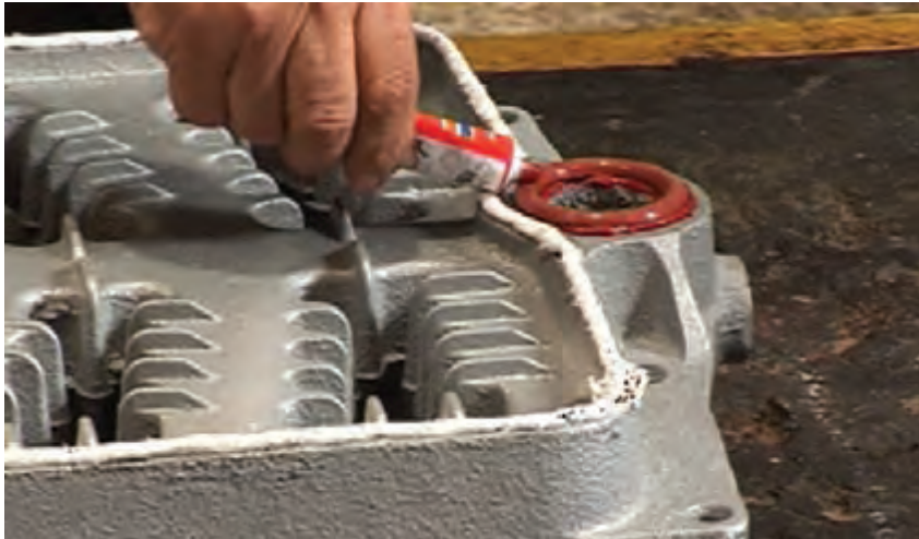
شکل ۲۰- استفاده از اورینگ به جای بوش
