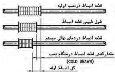
شکل ۱۹- لوله انبساط گیر
