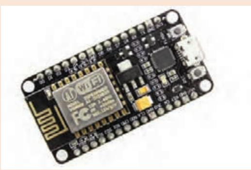
NodeMCU یک بُرد کاربردی و منبع باز در زمینه IOT می‌باشد که هسته اصلی آن تراشه آن‌ترش Wi-Fi است و امکان اتصال به شبکه Wi-Fi ESP8266 و انتقال اطلاعات میان اینترنت و دستگاه‌ها را فراهم می‌کند. از قابلیت‌های مهم NodeMCU امکان استفاده از برنامه آردوینو و دستورات آن برای برنامه‌ریزی مژول است.
