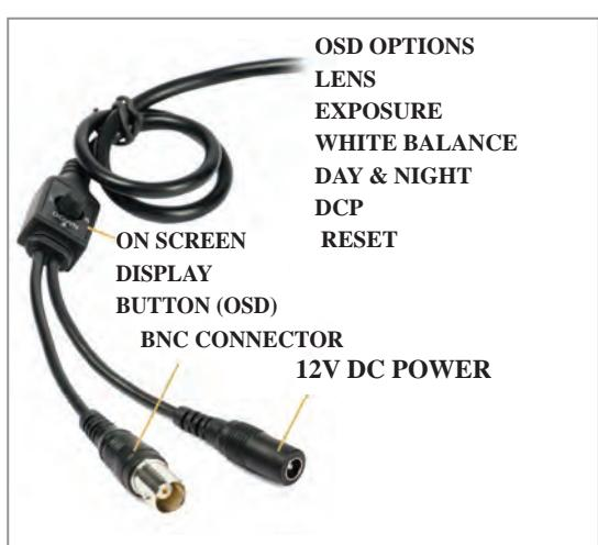
۳) **منو OSD**: اصطلاح OSD برگرفته از سرواژه‌هایی از واژه‌های On Screen Display menu می‌باشد و به معنای «منوی تنظیمات نمایش داده شده روی صفحه» است و کارایی این منو فقط تنظیمات تصویر دوربین است. البته رشد فناوری سیستم‌های نظارت تصویری این تنظیمات را بر بستر کابل کواکسیال و دستگاه ضبط و کنترل انتقال داده است.
