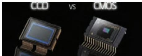
این سنسور قلب دوربین‌های مداربسته است. حسگر تصویر، نور عموری از روزنہ لنز به داخل دوربین را به یک سیگنال الکتریکی تبدیل می‌کند. حسگرهایی که امروزه در دوربین‌ها مورد استفاده قرار می‌گیرد دو نوع‌اند:
