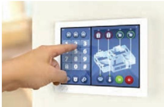
سیم‌کشی بیشتر سیستم‌های پیچیده و هوشمند، تحت شبکه انجام می‌شود و همین موضوع برای دیجیتال‌کردن سیستم دلیل مناسبی است. مهم‌ترین مزیت آنها تعریف تعداد زون بدون محدودیت، تعریف زون‌ها و اجزای سیستم توسط کدهای اختصاصی، امکان گزارش‌گیری و کنترل سیستم تحت وب و از همه مهم‌تر متصل نمودن سیستم به پنل مرکزی خانه هوشمند است.
