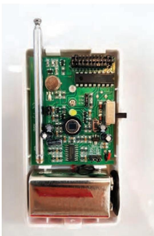
در بعضی مواقع که سیم‌کشی روکار، به دلیل مشکلات اجرا یا درخواست مشتری امکان ندارد، از سیستم‌های بی‌سیم استفاده می‌شود. دو فرکانس ۳۱۵ و ۴۳۳ مگاهرتز رایج‌ترین باندهای فرکانسی مورد استفاده در چنین سیستم‌هایی است. برندهای معتبری سیستم‌های باکیفیت بی‌سیمی را تولید و به بازار عرضه نموده‌اند، اما متأسفانه سیستم‌های بی‌کیفیتی وارد بازار ایران شده‌اند و همین موضوع، موجب مشکلات عدیدهای از جمله آلام کاذب یا عملکرد ضعیف حسگرها شده است. به همین دلیل از این سیستم‌ها زیاد استقبال نشده است.
