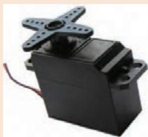
سرورو موتور شامل یک موتور الکتریکی ساده به همراه یک مدار فیدبک برای کنترل موقعیت، سرعت و گشتاور است. این موتورها در اندازه های کوچک برای مصارف مکاترونیکی و رباتیکی تا اندازه های بزرگ برای دستگاه های صنعتی ساخته می شوند. سروو موتورها عموماً قیمت بالایی دارند و در پروژه هایی که سرعت، دقت بالا و گشتاور متغیر و بالا مدنظر باشد، به کار گرفته می شوند.
