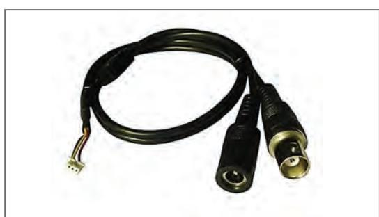
۲) **خروچی تصویر (Video Output)**: دامنه سیگنال تصویر خروچی دوربین‌های مداربسته حدود یک ولت پیکتاپیک است، که از طریق این کانکتور (فیش) دریافت می‌شود. این خروچی در دوربین‌های مینی و مخفی معمولاً به صورت فیش مادگی AV زرد رنگ است، ولی در اکثر دوربین‌های آنالوگ بزرگتر، به صورت یک کانکتور (فیش) BNC است. در دوربین‌های دیجیتال (تحت شبکه) نیز این خروچی از نوع مادگی کانکتور RJ45 (کابل LAN) است.
