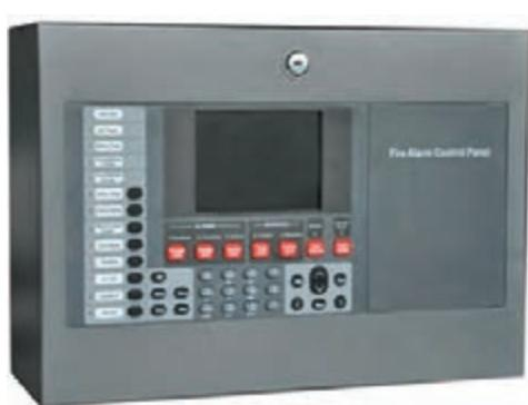
کنترل پنل (FACP) سیستم آدرس پذیر کاملاً متفاوت از سیستم متعارف عمل می کند. به گونه ای که در این سیستم، تکنیک <sup>۱</sup>Multiplex اجازه می دهد هر دتکتور مستقل اطلاعات را به پنل کنترل ارسال نماید. در هر
