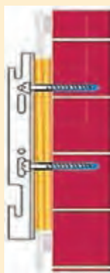
دتایل نصب بست رادیاتور پنل
