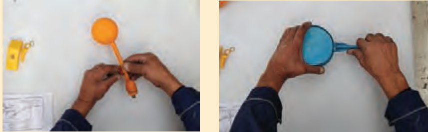
نحوه تنظیم انواع شناور
