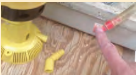
اتصال شیلنگ آب پخش کن به پمپ
