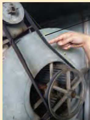
آزمایش سفتی تسمه
