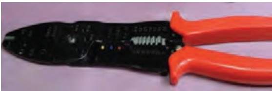
سر سیم یا فیش مخصوص و ابزار پرس
