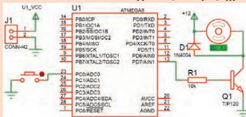
شکل ۷-۳۳ مدار کنترل موتور توسط میکروکنترلر
