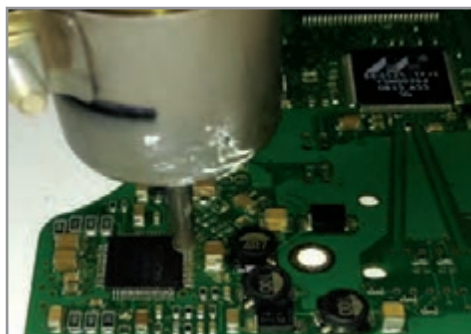
شکل ۲-۴ دمونتاز آی سی های چهار طرفه (خرچنگی)
