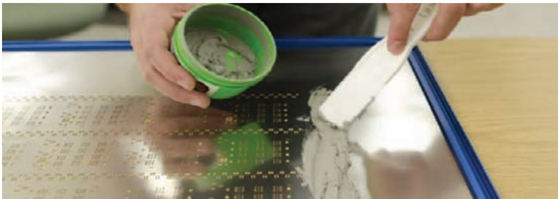
شکل ۱۲-۳ خمیر اندود کردن لحیم به کمک شابلون
