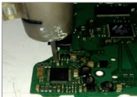
شکل ۲-۴ دمونتاز آی سی های چهار طرفه (خرچنگی)
