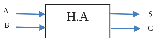
شکل ۵-۲ بلوک دیاگرام جمع کننده ناقص
