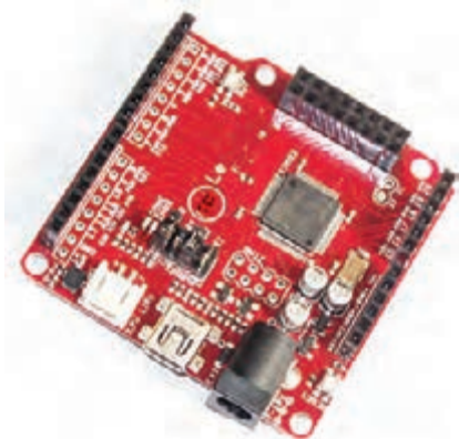
ب) برد مدار چاپی پروژه میکروکنترلر
