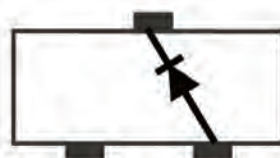
شکل ۱-۳۱ دیود در بسته دارای سه پایه (ترانزیستوری)
