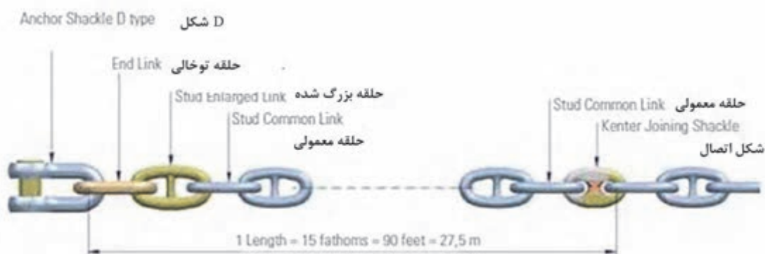
شکل ۳-۵- نحوه قرار گرفتن شکل‌ها و حلقه‌ها در یک طول زنجیر لنگر
