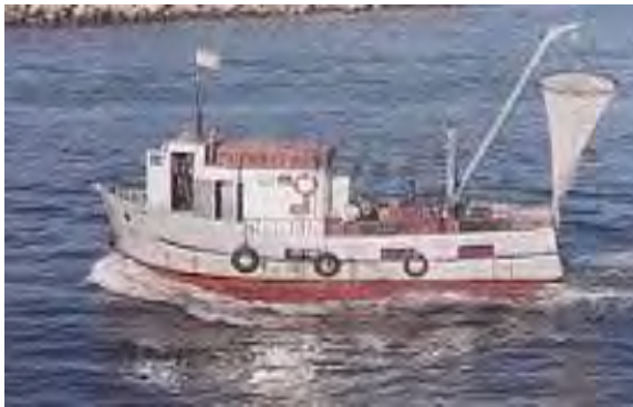
شکل ۴۱- شناورهای ماهیگیری مجهز به تور قیفی ویژه صید ماهی کیلکا در دریای خزر
