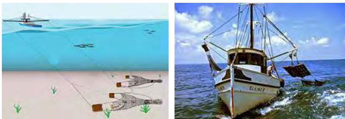
شکل ۵۲- کشتی صیادی ترالردو بازویی در حین عملیات تور اندازی و موقعیت تورها در حین صید
