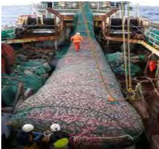
شکل ۵۱- خاتمه عملیات تورکشی و استقرار تور ترال بر روی عرشه در یک کشتی ترالر پاشنه کش
