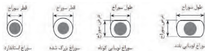
شکل ۹۹ ▲ انواع سوراخ پیچ‌ها در اتصالات پیچی
