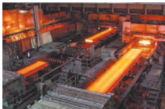
شکل ۳ ▲ نورد گرم ورق فولادی
