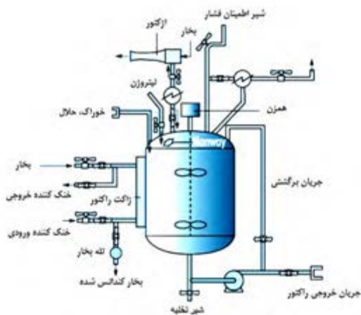
شکل ۹-۴- راکتور مخزنی همزن دار پیوسته به همراه جزئیات
