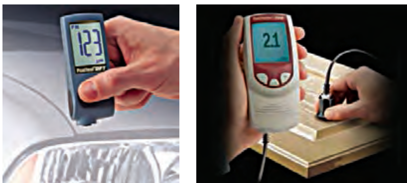
شکل ۲۲- انواع ضخامت‌سنج فیلم خشک رنگ (غیر تخریبی)
