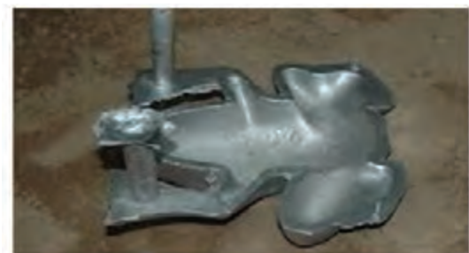
شکل ۲- یک قطعه خام با ناصافی‌ها در سطح
