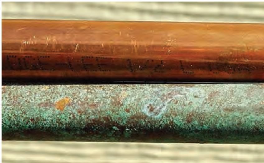
شکل ۲۹- تغییر رنگ لوله مسی در مجاورت هوای مرطوب
