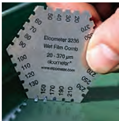
شکل ۱۹- شانۀ مخصوص اندازه‌گیری ضخامت فیلم تر رنگ
