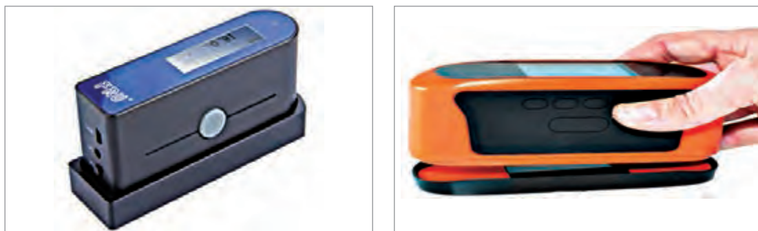
شکل ۲۰- دو نمونه دستگاه برآقیت سنج رنگ
