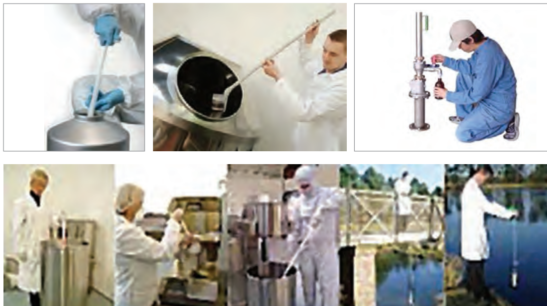
شکل ۱۳- تعدادی از تجهیزات و شیوه‌های مختلف نمونه‌گیری مایعات
