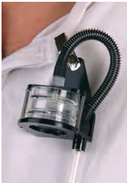
نصب صافی در ناحیه تنفسی شخص نمونه‌گیر
