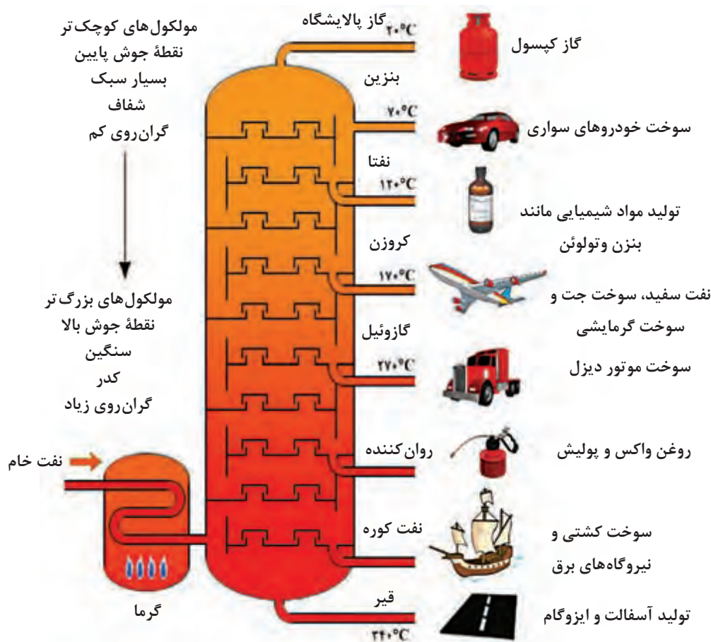
شکل ۲ - جداسازی صورت گرفته بر روی نفت خام در یک واحد پالایشگاهی
