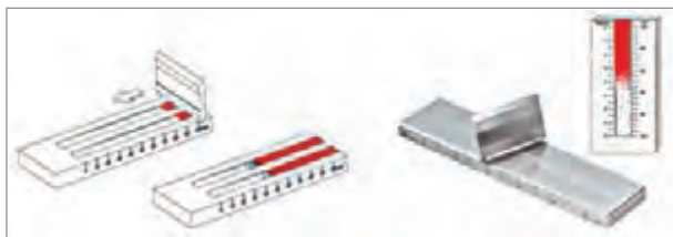
شکل ۱۷- وسیلهٔ اندازه‌گیری دانه‌بندی رنگ تر
