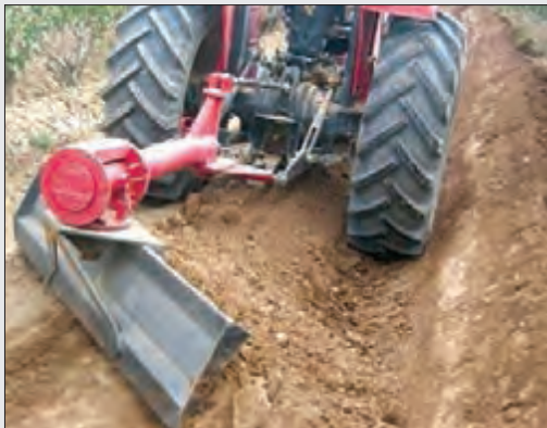
شکل ۲۷-۲- زاویه تیغه و ریزش خاک در چاله
