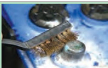
شکل ۱۷-۱- تمیز کردن قطب‌ها با برس سیمی
