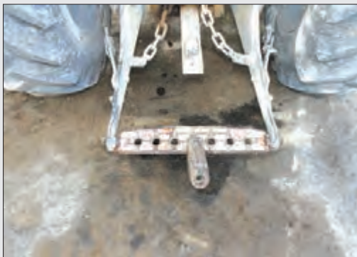
شکل ۲۹-۴- مالبند بلند و اتصال سه نقطه
