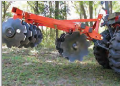
شکل ۲۹-۴- مالبند بلند و اتصال سه نقطه
