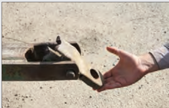
شکل ۱۲-۵- شکستگی نقطه اتصال صاف کننده
