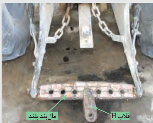
شکل ۱۵-۵- مال‌بند بلند برای اتصال ماشین هموارکننده نیمه‌سوار
