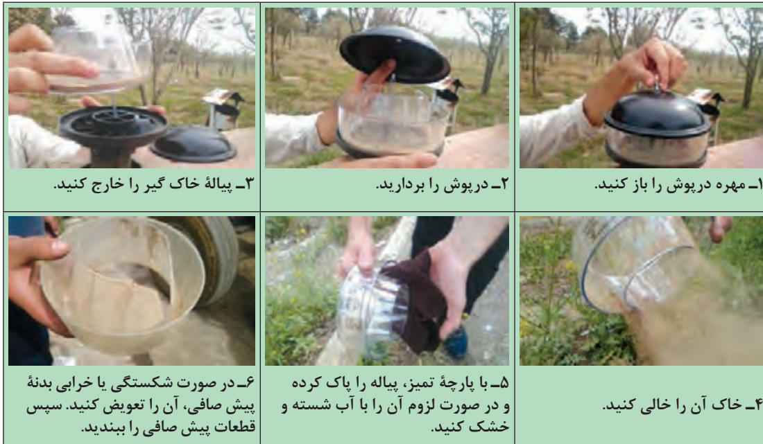
شکل ۳۱-۱- مراحل تمیز کردن پیش صافی
