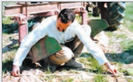
شکل ۳۷-۳- اندازه‌گیری عرض کار گاواهن برگردان دار
