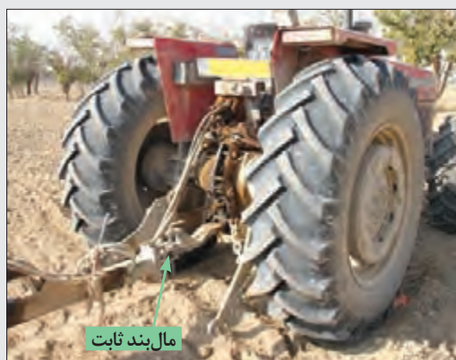
شکل ۱۶-۵- نقطهٔ اتصال در صاف‌کننده کششی
