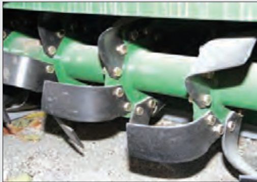
شکل ۲۲-۴- وضعیت درپوش و تیغه‌ها در گاوآهن دوار
