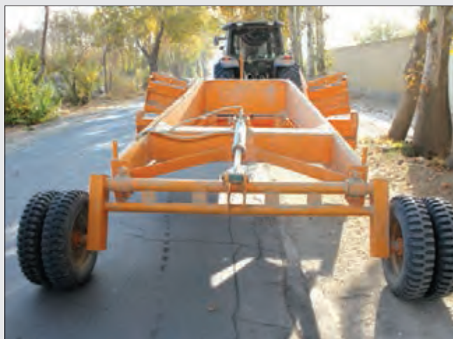
شکل ۱۸-۵- تنظیم وضعیت چرخ ها به روش مکانیکی
