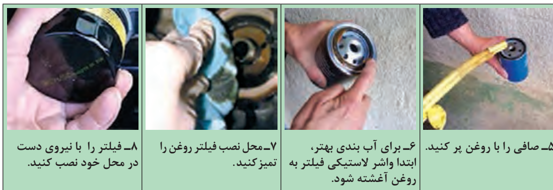
شکل ۵۰-۱- مراحل تعویض صافی روغن
