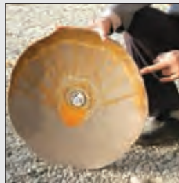
شکل ۱۸-۴- شکستگی نقطه اتصال و بشقاب
