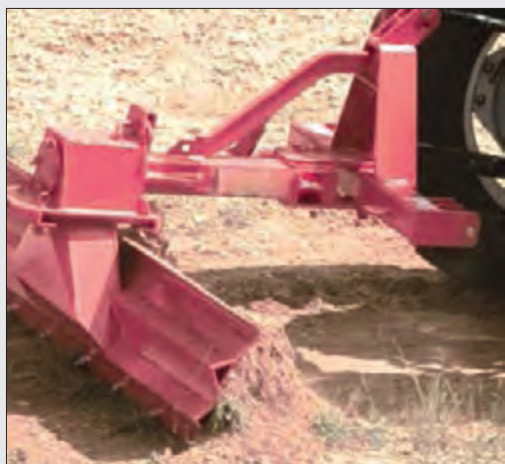
شکل ۲۶-۲ تیغه پشت تراکتوری متصل به تراکتور
