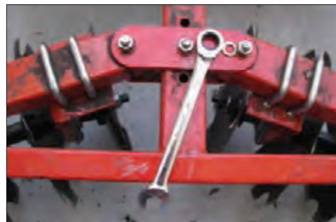
شکل ۲۸-۴- تغییر زاویه استقرار ردیف بشقاب‌ها روی شاسی
