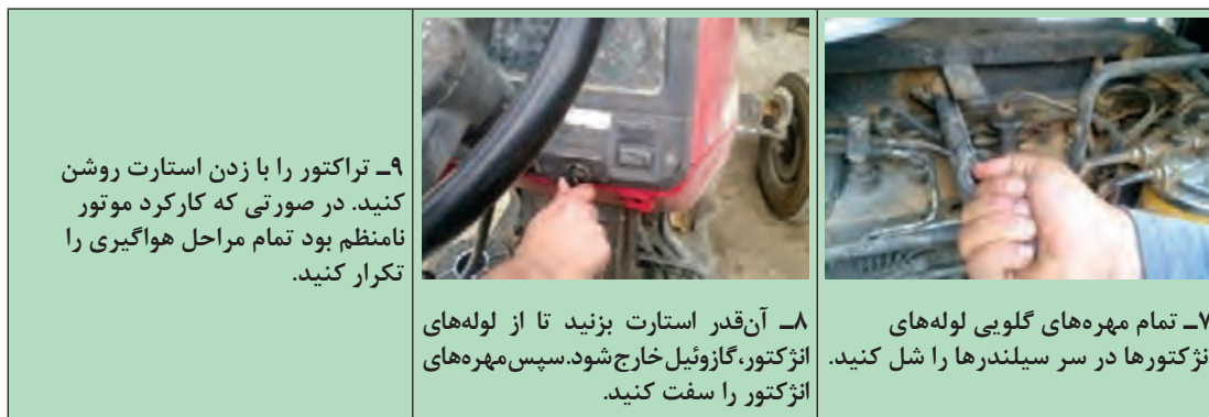
شکل ۴۰-۱- مراحل هواگیری سیستم سوخت رسانی
