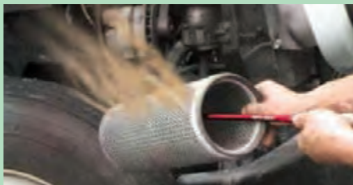
شکل ۳۵-۱- تمیز کردن صافی خشک با فشار هوا
