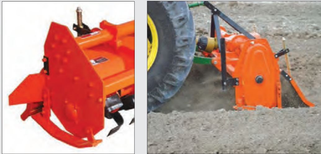
شکل ۳۴-۴- تنظیم درپوش و عمق کار
