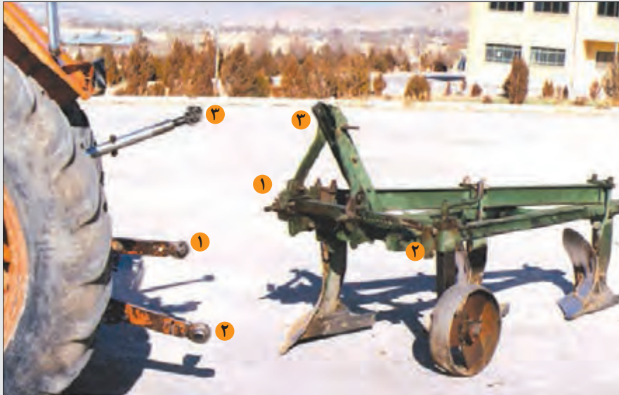
شکل ۲۸-۳- اتصال گاواهن به تراکتور
