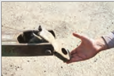
شکل ۱۸-۴- شکستگی نقطه اتصال و بشقاب
