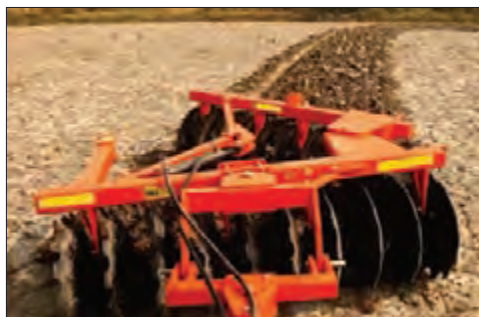
شکل ۲۸-۴- تغییر زاویه استقرار ردیف بشقاب‌ها روی شاسی
