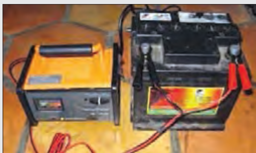
شکل ۵۲-۱- روش شارژ باتری با شارژر
