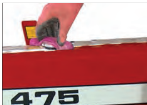
شکل ۴۵-۱ نحوه باز کردن درب رادیاتور
