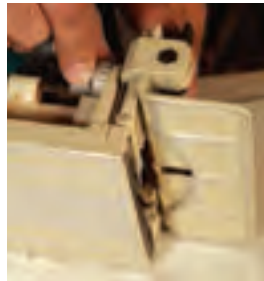
شکل ۱-۱۸۴- تنظیم عمق کنشکاف
