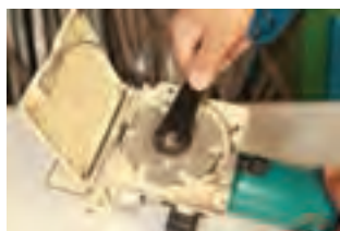
شکل ۱-۱۸۳-ب - روش تعویض تیغه
