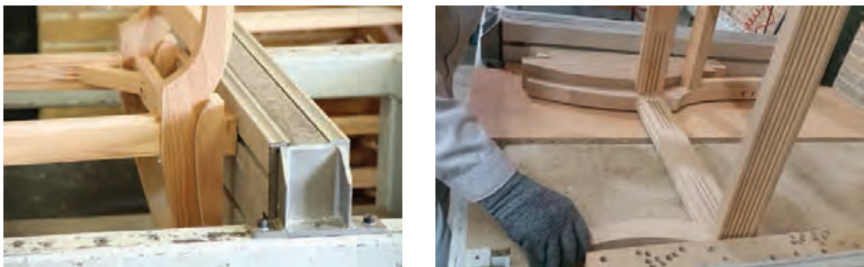
شکل ۵۵- جا زدن اتصالات با تنگ پنوماتیکی
