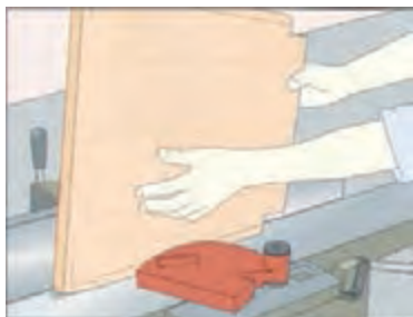
پرداخت کردن کفی با دستگاه کفرند
