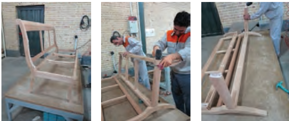
شکل ۵۴- مونتاژ مجموعه پشتی مبل با جلو مبل توسط قیدهای بغل
