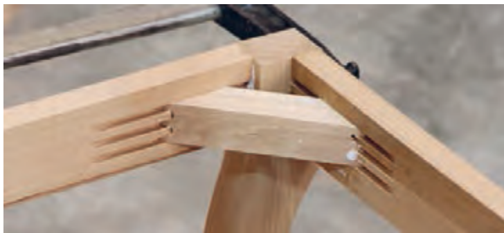
شکل ۱۲- اتصال انگشتی نبشی (بلوک سه‌گوش)
