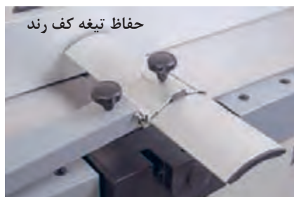
شکل ۳- نمونه‌هایی از حفاظ‌های مخصوص تیغه هر دستگاه
