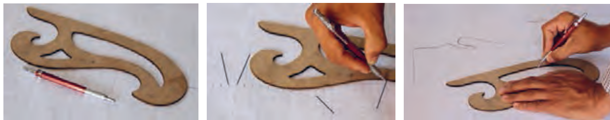
شکل ۶۴- ابزار ترسیم، شابلون به صورت نقطه‌یابی و انتقال طرح روی کاغذ شطرنجی
