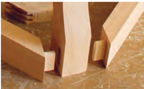
شکل ۱۰- اتصال و زبانه مخفی
