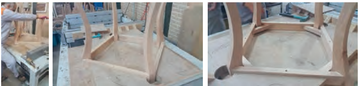
شکل ۶۶- محکم کردن پایه‌ها و قیده‌ها توسط تنگ پنوماتیک
