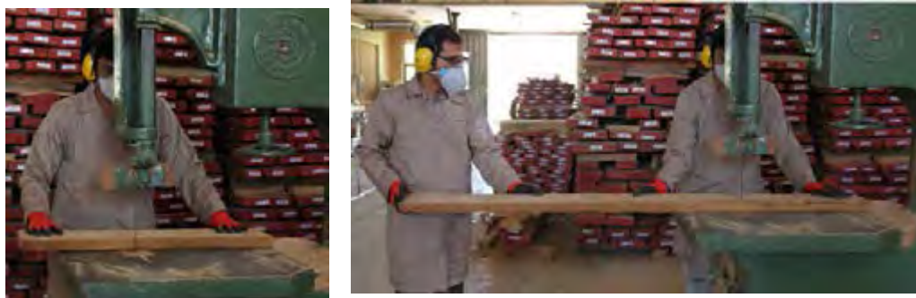
شکل ۶۹- برش عرضی قطعات بزرگ با استفاده از فرد کمکی و برش عرضی قطعات کوچک
