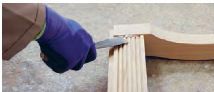
شکل ۱۰۲- تمیز کردن چسب اضافی با کاردک
