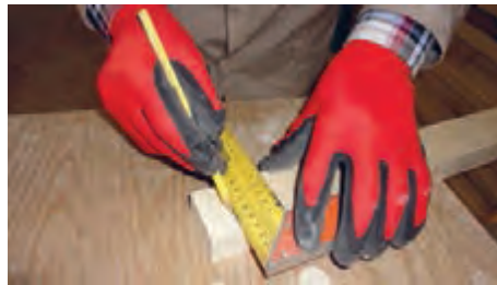
شکل ۸۷- علامت زدن قطعات مختلف برای انجام اتصال
