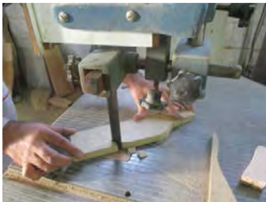
شکل ۶۲- عملیات قوس‌بری با دستگاه اره نواری
