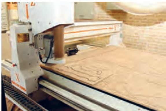
شکل ۶۷- تهیه شابلون با دستگاه فرز CNC
