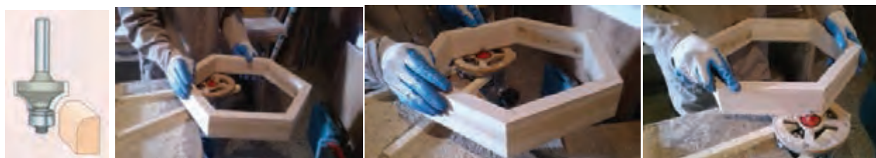
شکل ۳۹- پرداخت با تیغ نیم‌گرد به وسیله دستگاه اورفرز دستی
