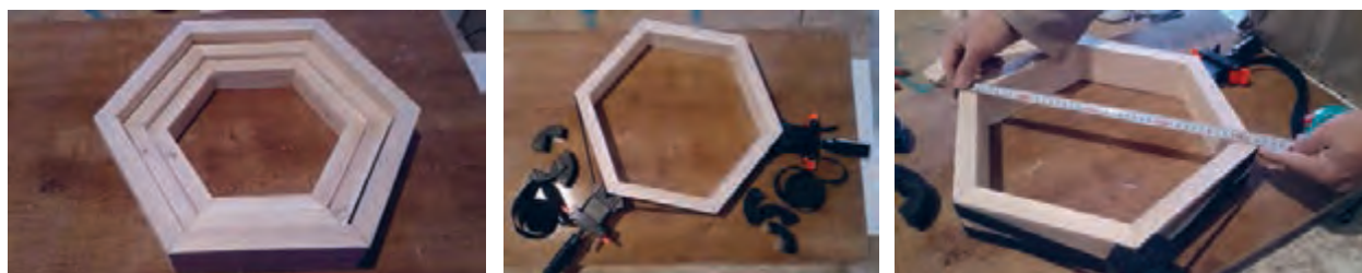
شکل ۳۸- کنترل دوئیدگی و صحیح بودن قاب‌های شش ضلعی‌ها
