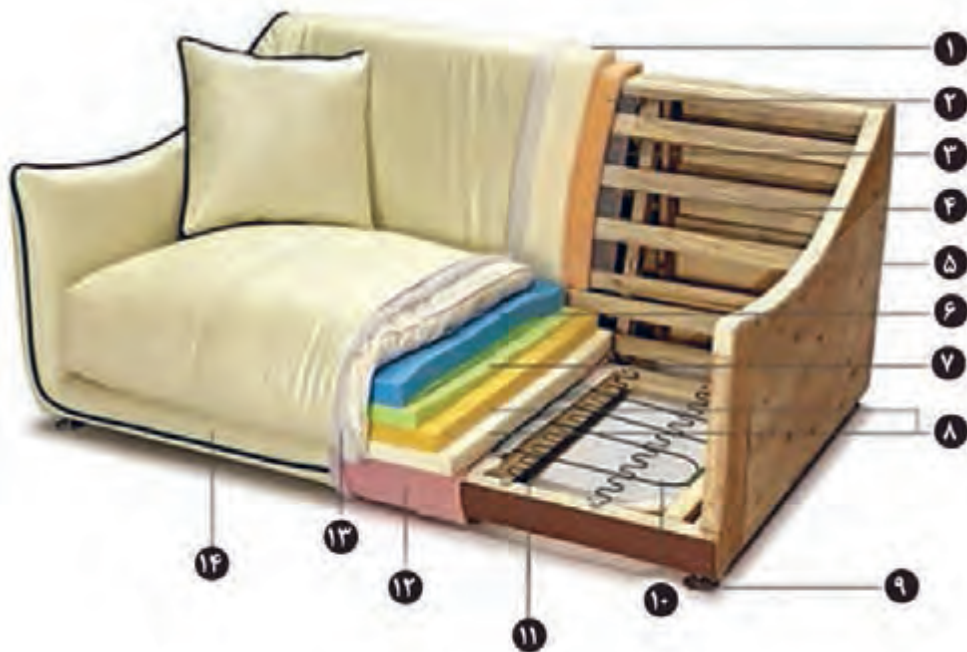
شکل ۱- مبلی راحتی و برشی از مواد به کار رفته در آن
