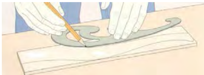
شکل ۴۲- آماده کردن الگوی پایه به وسیله پیستوله
