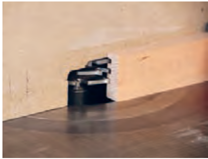
شکل ۶۱- تیغ فرز مخصوص زهوار صفحه
