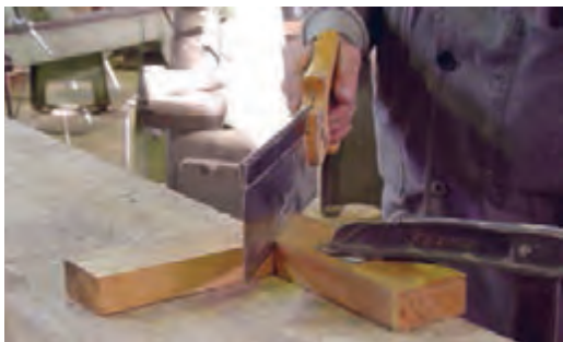
شکل ۲۱ - چگونگی اره‌کشی درز بین اتصال
