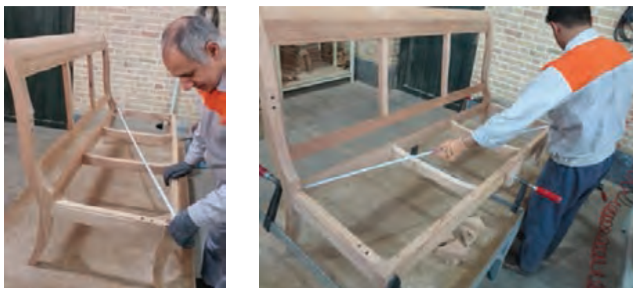
شکل ۵۷- کنترل دوئیدگی (گونیا)ی کردن کار) با متر
