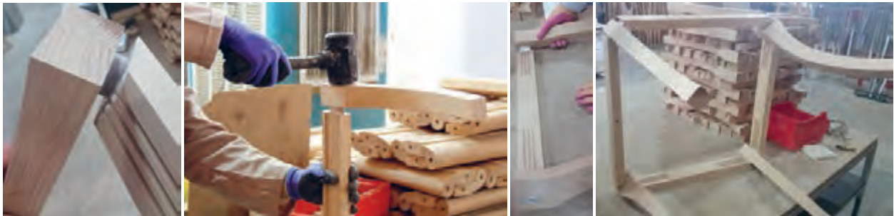
شکل ۶۵- جا زدن زبان‌ها و مراحل مونتاژ پایه‌ها و قیده‌های جلو
