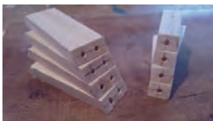
شکل ۳۳- سوراخ کردن قیده‌ها تحت زاویه
