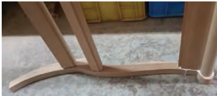
شکل ۴۸- جا زدن پشتی مبل
