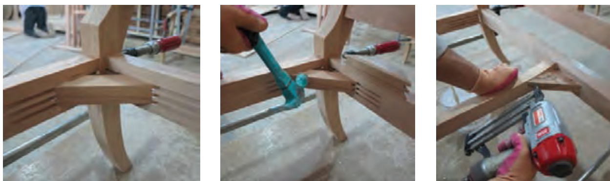
شکل ۵۸- جا زدن نبشی‌های گوشه
