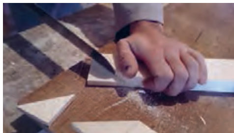
شکل ۱۶- عملیات برشکاری اتصال نیم و نیم یک رو فارسی
