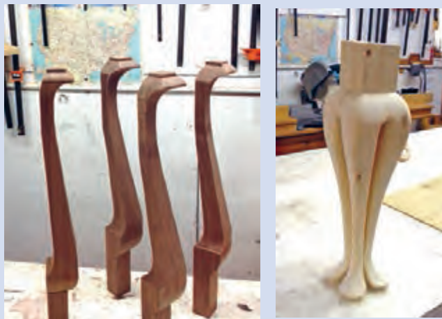
شکل ۵۱- آماده شدن پایه‌ها برای ایجاد کام
