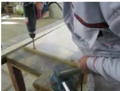
شکل ۶۶- عملیات اتصال دوبل به وسیله دریل دستی
