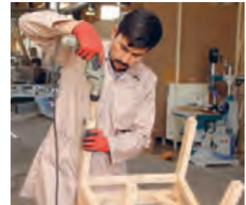
شکل ۱۱۲- سوراخکاری کف پایه با دریل
