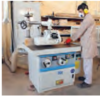
شکل ۶۰- ایجاد اتصال انگشتی با دستگاه فرز میزی و استفاده از دستگاه هدایت
