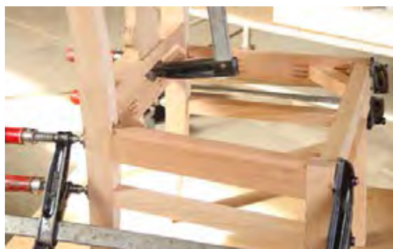
شکل ۱۱۰- نصب نبشی ها
