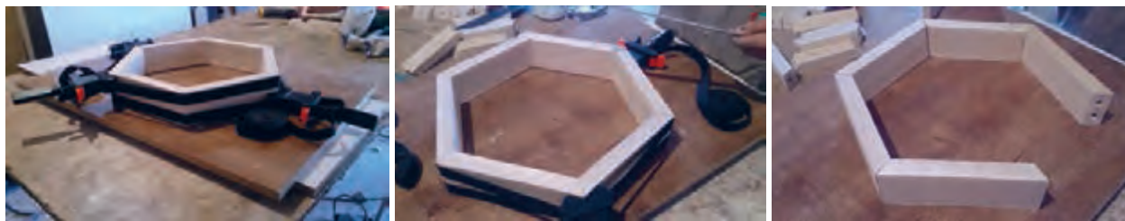
شکل ۳۷- جا زدن قیدها و بستن با گیره تسمه‌ای
