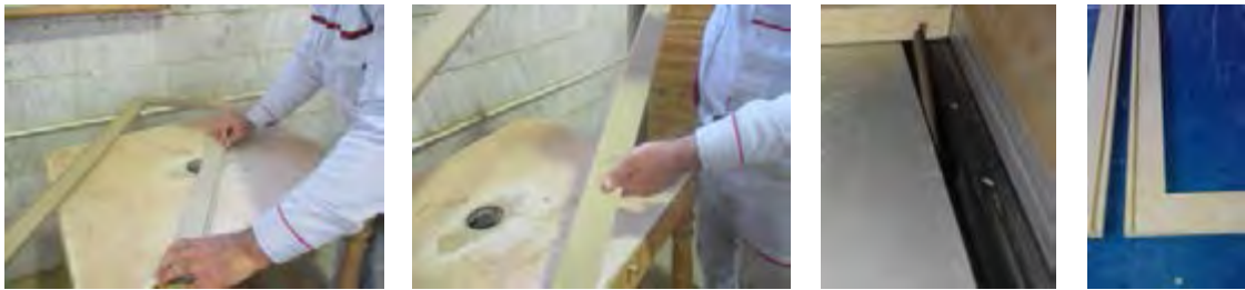
شکل ۷۴- ایجاد شیار به عمق ۸ و پهنای ۵ میلی متر برای قرارگیری آینه
