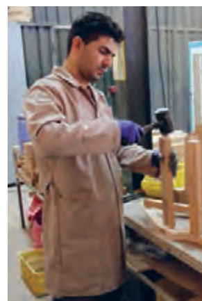
شکل ۱۰۱- استفاده از چکش لاستیکی برای جا زدن زبانه‌ها و مراحل مونتاژ پایه‌ها و قیده‌های جلو
