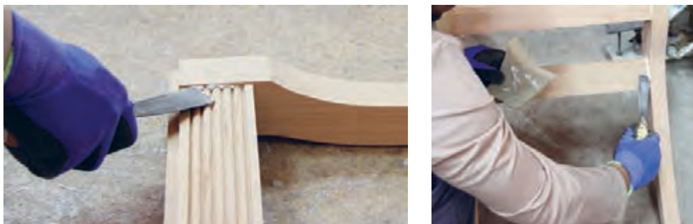
شکل ۶۷- تمیز کردن چسب اضافی با کاردک
