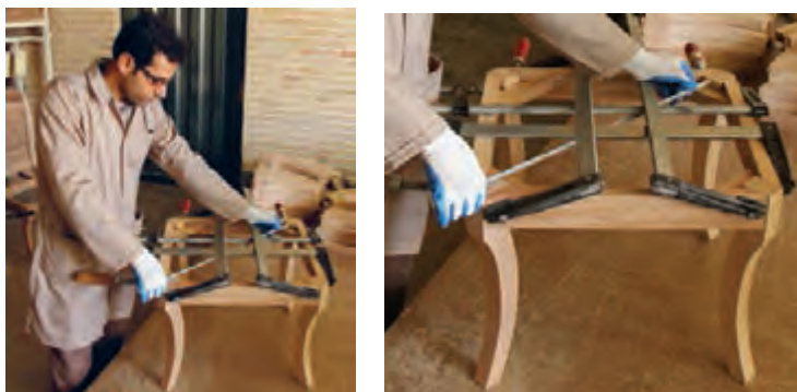
شکل ۶۹- کنترل دوئیدگی با متر
