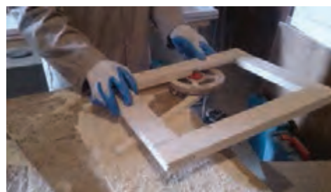
شکل ۲۶- پرداخت با تیغ نیم‌گرد و به کمک دستگاه اورفرز دستی
