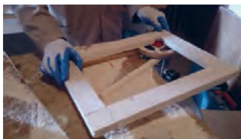
شکل ۲۶- پرداخت با تیغ نیم‌گرد و به کمک دستگاه اورفرز دستی
