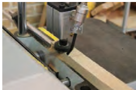
شکل ۴۰- اتصال کام با دستگاه کام کن نیمه‌اتوماتیک
