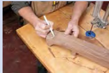
شکل ۴۷- خط‌کشی دوباره روی چوب
