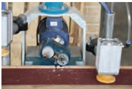
شکل ۳۸- ایجاد اتصال با دستگاه دوپل زن نیمه‌اتوماتیک
