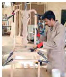
شکل ۱۰۷- جا زدن نبشی به وسیله چکش پلاستیکی
