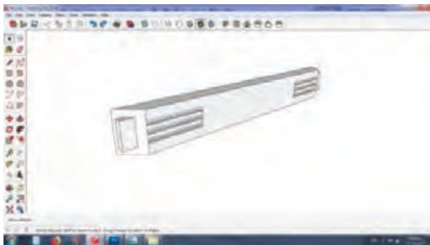
شکل ۲۵- حجم دادن به اتصال شانه‌ای
