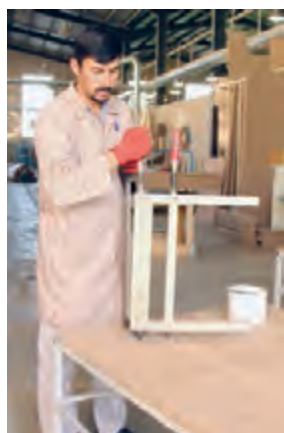
شکل ۱۰۱- استفاده از چکش لاستیکی برای جا زدن زبانه‌ها و مراحل مونتاژ پایه‌ها و قیده‌های جلو
