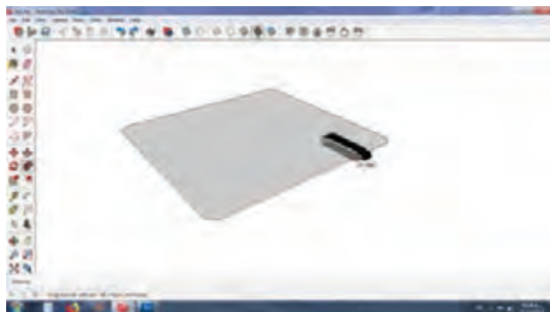
شکل ۳۳- تبدیل سطح مقطع به حجم
