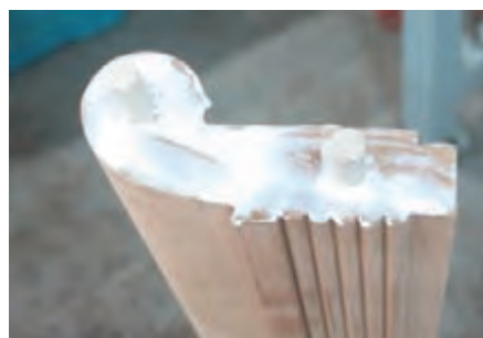
شکل ۴۶- روش چسب زدن اتصال دوبل پایه‌های عقب
