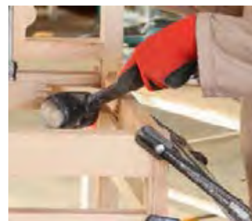
شکل ۱۰۷- جا زدن نبشی به وسیله چکش پلاستیکی
