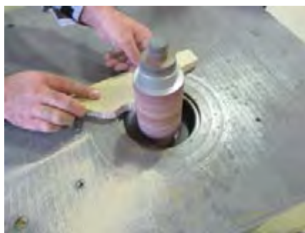
شکل ۶۴- عملیات پرداخت با دستگاه فرز میزی (تویی سنباده)
