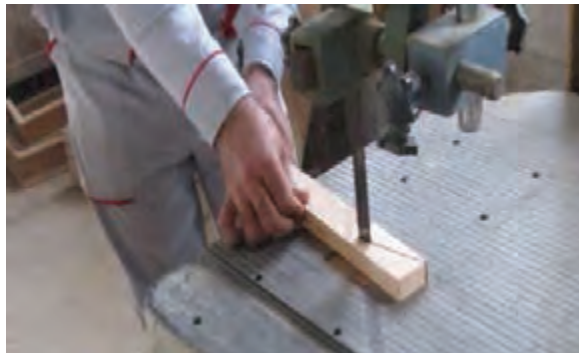
شکل ۶۳- پایان قوس بری با دستگاه اره نواری
