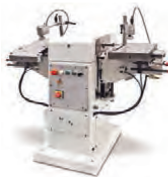
شکل ۵۴- کام کندن چوب با دستگاه کام کن نیمه اتوماتیک
