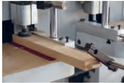
شکل ۹۲- عملیات برش زبانه با دستگاه زبانه‌زن نیمه اتوماتیک
