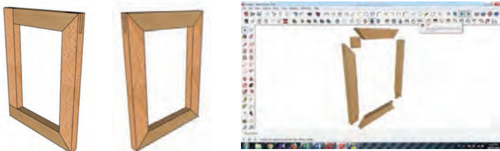
شکل ۱۴- مونتاژ قاب چوبی
