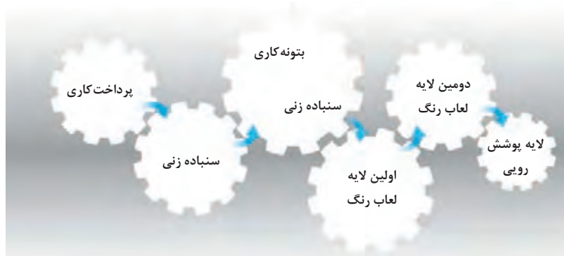
شکل ۱۱۵- مراحل اجرای رنگ کاری
