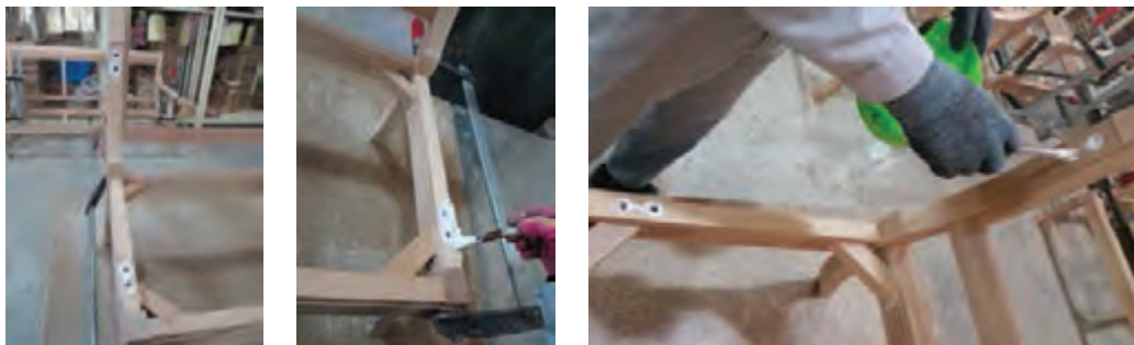
شکل ۵۹- چسب زدن محل اتصالات دسته مبل
