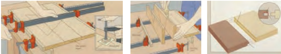
شکل ۲۹- نحوه درز کردن اتصالات عرضی
