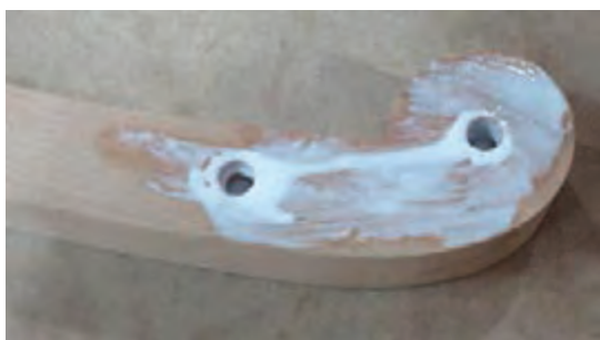
شکل ۴۶- روش چسب زدن اتصال دوبل پایه‌های عقب
