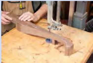
شکل ۴۹- قوس‌بری چوب: مرحله دوم
