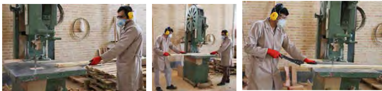
شکل ۶۸- استفاده از فرد کمکی برای گرفتن انتهای چوب‌های بلند و برش طولی چوب با استفاده از چوب کمکی
