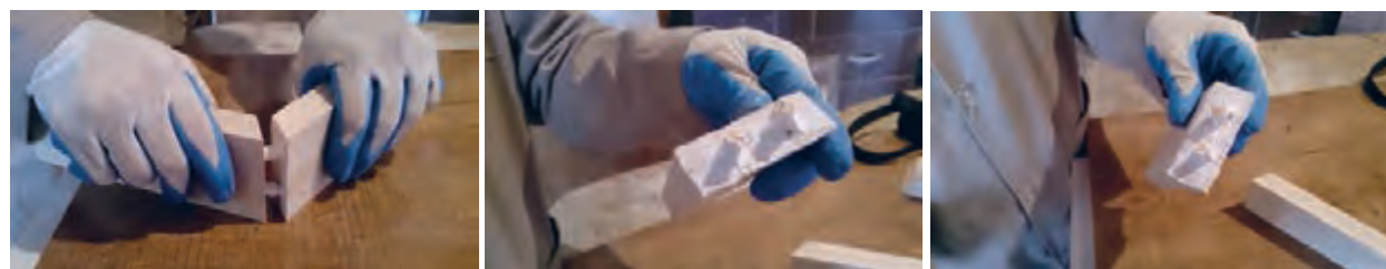
شکل ۳۶- چسب زدن سطح قیدها و جا زدن میخ چوبی در محل اتصال
