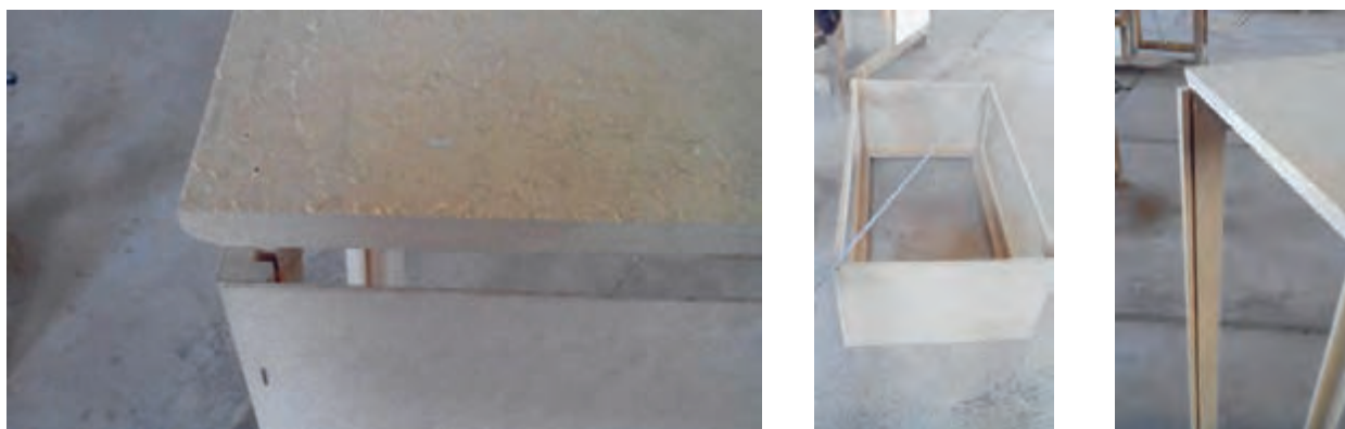
شکل ۷۸- کنترل دوئیدگی و پترین قبل از پشت کوبی (شیار آینه قابل مشاهده است)
