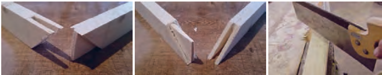
شکل ۲۰- برشکاری اتصال دو رو فارسی
