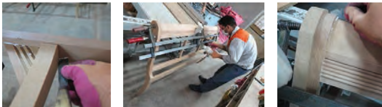
شکل ۵۲- تمیز کردن چسب اضافی روی قطعه کار
