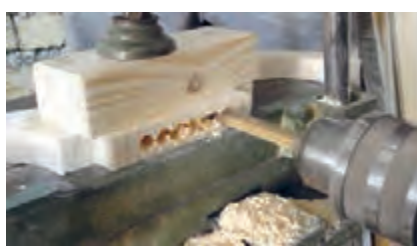
شکل ۸۸- عملیات کم کنی با دستگاه سه کاره
