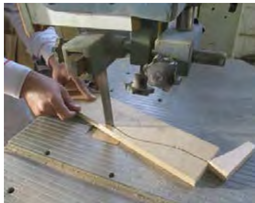
شکل ۶۲- عملیات قوس‌بری با دستگاه اره نواری
