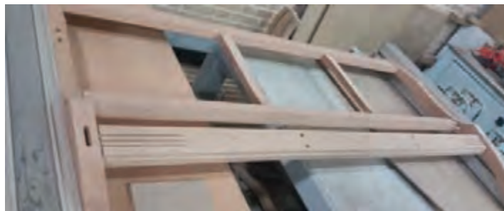
شکل ۵۰- جا زدن پشتی مبل با تنگ پنوماتیکی
