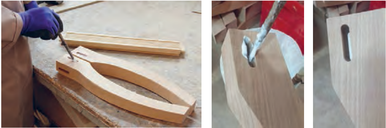
شکل ۶۴- چسب زدن کام پایه‌ها
