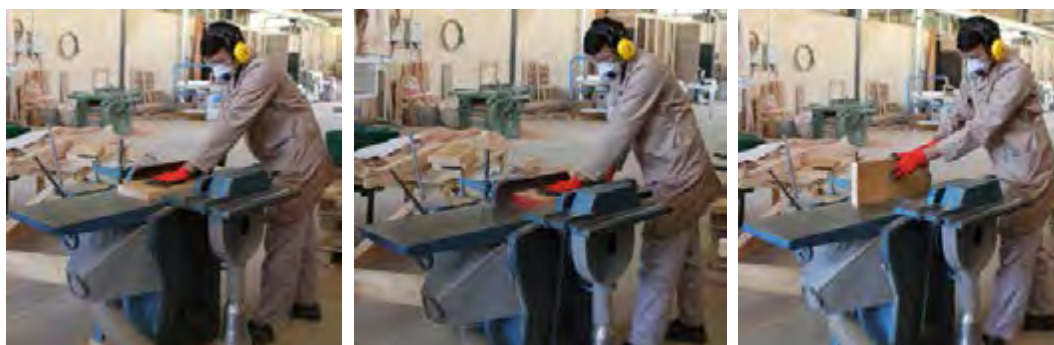
شکل ۷۰- یک رو و یک نرکردن چوب
