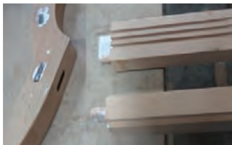
شکل ۴۵- روش چسب زدن با قلم‌مو داخل کام پایه‌های عقب
