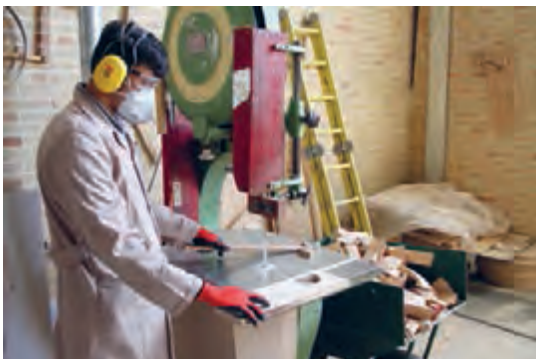
شکل ۸۲- استفاده از چوب کمکی برای ریختن قطعات اضافی در گاری به منظور تمیزی و نظم در کارگاه
