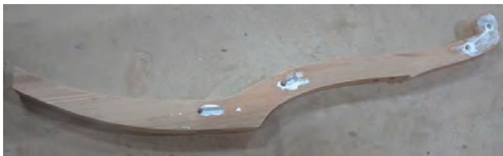
شکل ۴۶- روش چسب زدن اتصال دوبل پایه‌های عقب
