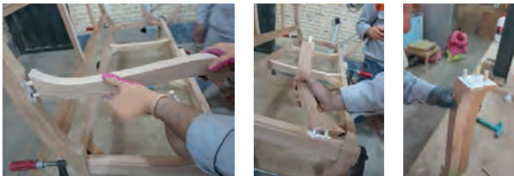
شکل ۶۰- جا زدن دسته مبل در محل اتصالات
