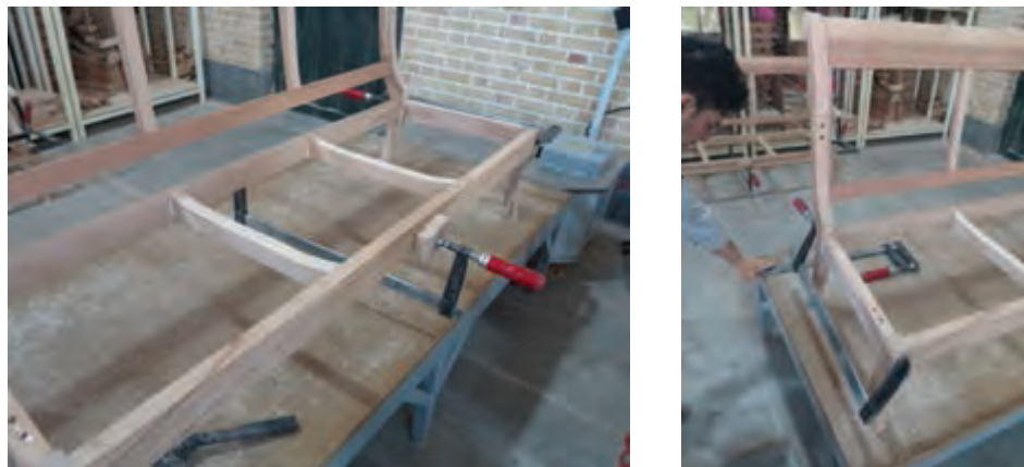
شکل ۵۶- جا زدن اتصالات با گیره دستی
