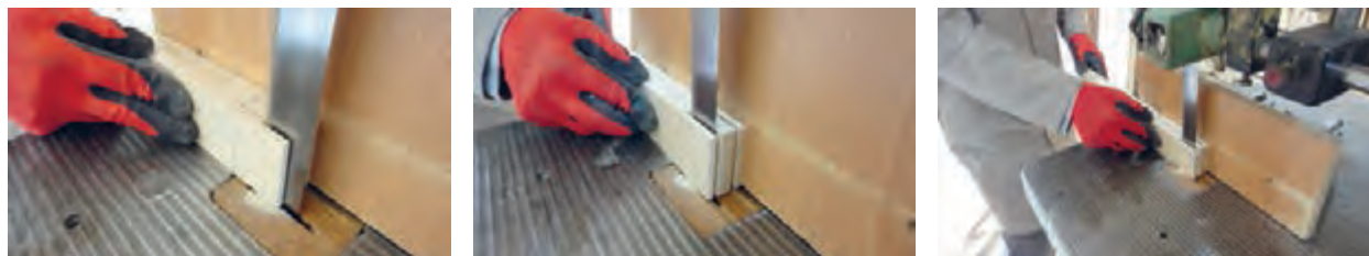
شکل ۹۰- عملیات برش زبانه با دستگاه اره نواری
