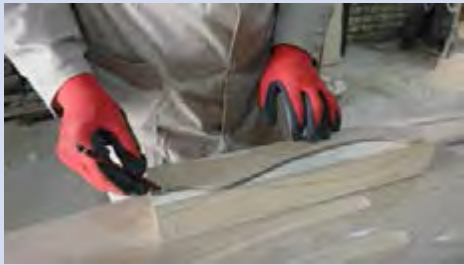
شکل ۴۵- انتقال الگوی پایه میز عسلی از روی شابلون به روی چوب
