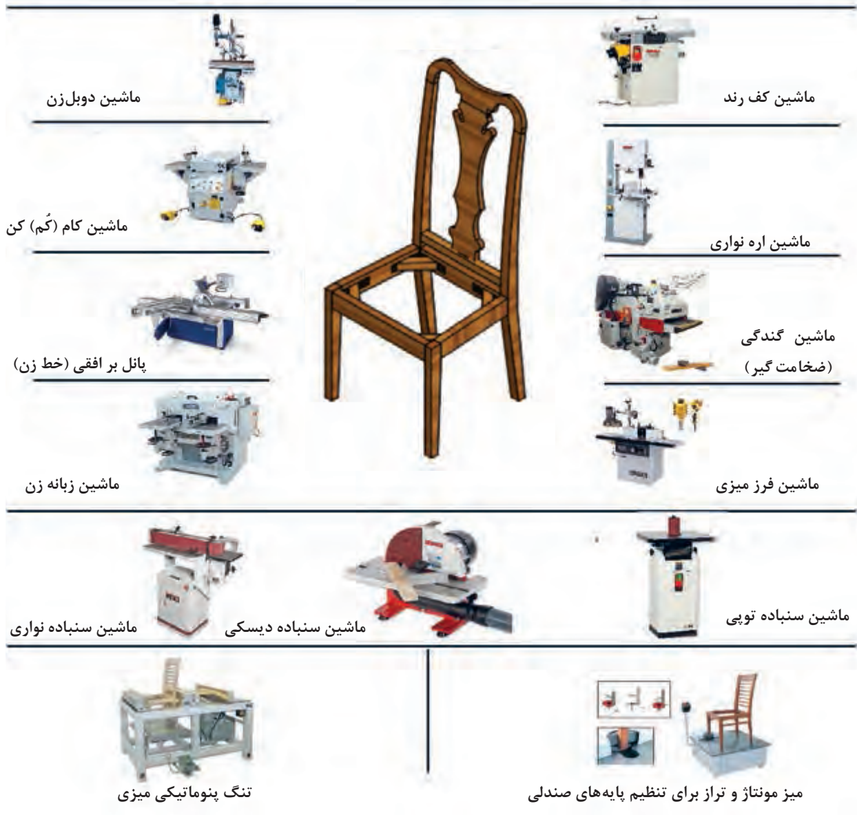
شکل ۲۵- ماشین آلات مورد استفاده در ساخت پروژه
