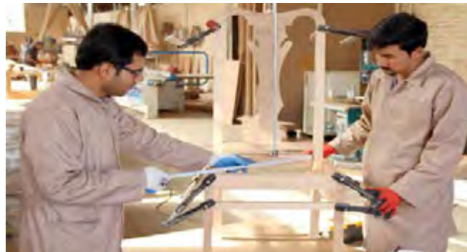
شکل ۱۰۹- کنترل دوئیدگی با متر
