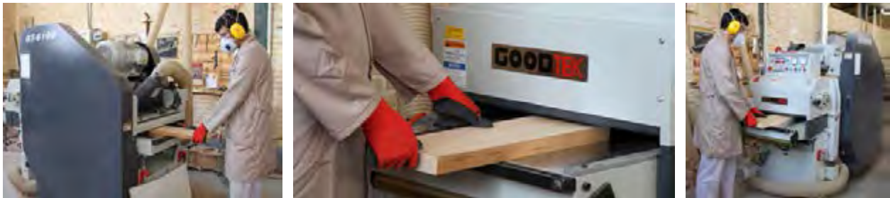
شکل ۷۱- یک ضخامت کردن چوب با دستگاه گندگی (ضخامت‌گیر)
