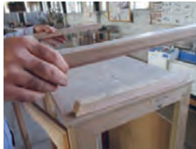
شکل ۸۱- نصب تاج به بدنه
