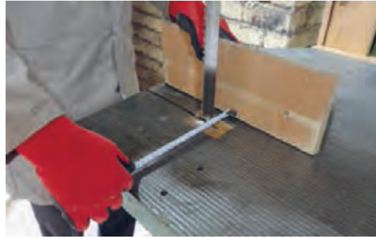
شکل ۷۴- اندازه‌گیری فاصله تیغه با گونیا
