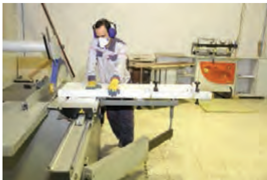
شکل ۷۶- برش توسط دستگاه پانل بر
