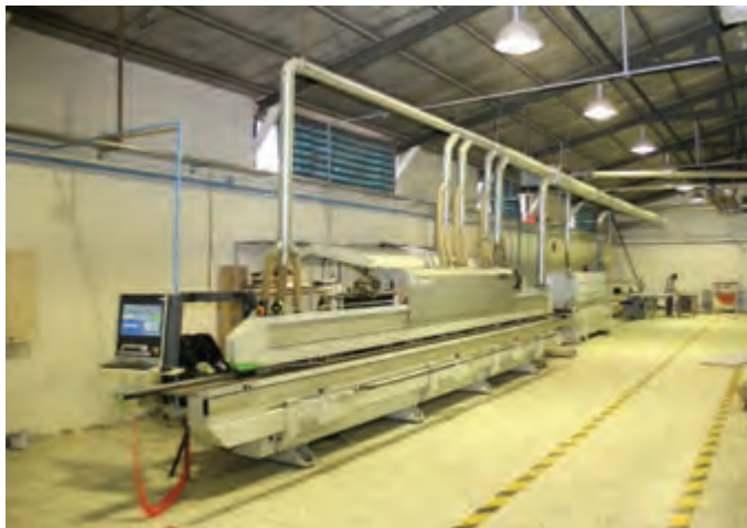
شکل ۱۲- نحوه اتصال مکنده‌های ثابت
