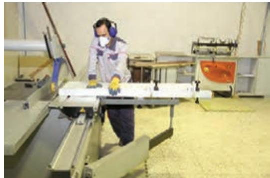
شکل ۷۶-برش توسط دستگاه پانل بر
