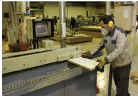
شکل ۷۹- نوار کردن قطعه کار
