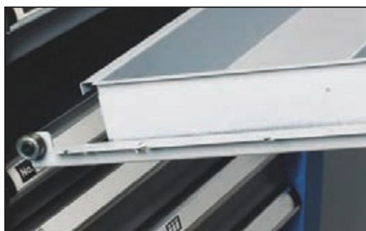
شکل ۱۲- استفاده ریل غلتکی در کشوهای فلزی
