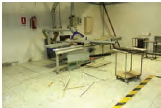
شکل ۷۷- انداختن ضایعات در کف کارگاه
