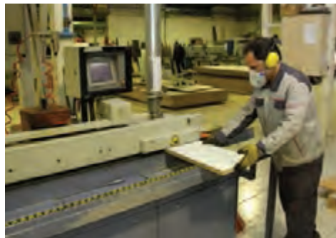
شکل ۷۹- نوار کردن قطعه کار
