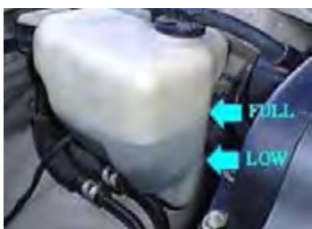
۸ اگر سطح مایع درون مخزن انبساط کمتر از Min باشد با اضافه کردن مخلوط آب و ضدیخ به اندازه مناسب سطح مایع تنظیم شود.
