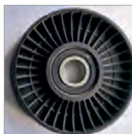
خارج از مرکز بودن پولی و هرزگردها نسبت به محور
