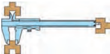
شکل ۹-۱- اندازه گیری با کولیس
