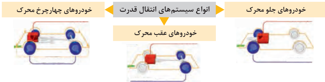
شکل ۱-۲۰- اجزای اصلی سیستم انتقال قدرت
