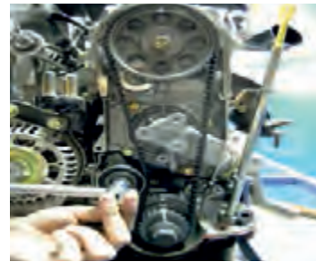
۴ پس از قفل کردن میل لنگ و میل بادامک تسمه سفت‌کن باز شود.
