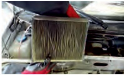
۲ فیلتر کهنه را از جای خود خارج و جای قرارگیری فیلتر تمیز شود.
