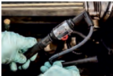
شکل ۸-۱۶- دستگاه آزمایش جرقه
