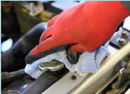
شکل ۱۷-۷- پاشش آب رادیاتور
