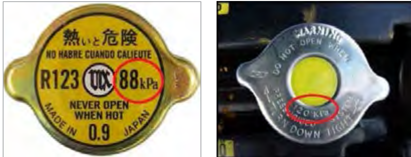
شکل ۲۵-۷- محل نوشته شدن فشار کارکرد روی در چند رادیاتور
