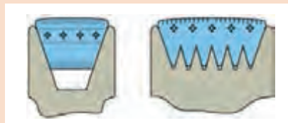
شکل ۲-۵- تسمه دوزنقه‌ای و شیاردار
