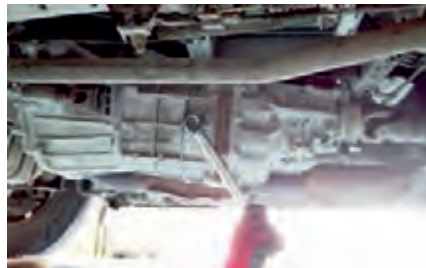
شکل ۴-۴- روش بررسی سطح و رنگ روغن جعبه‌دنده عقب محرك
