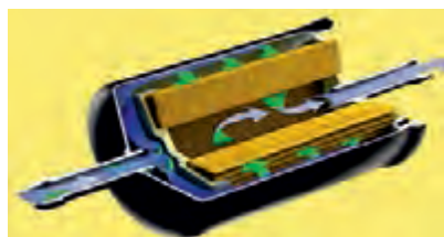
شکل ۳۱-۳- ساختمان فیلتر بنزین
