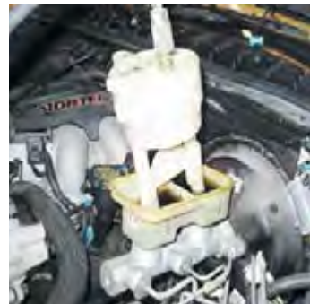
شکل ۱۴-۶- عوض کردن و هواگیری سیستم هیدرولیک ترمز با دستگاه تزریق تحت فشار
