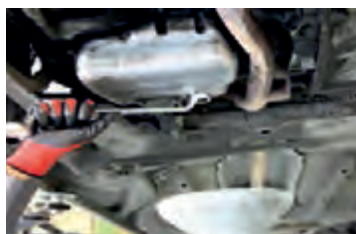
۵ پیچ تخلیه روغن موتور را باز کنید. (برای تخلیه بهتر و سریع تر روغن، در ورودی روغن موتور (درپوش سرسیلندر) باز باشد).
