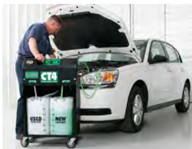
شکل ۲۷-۷- روش های تخلیه مایع خنک کننده
