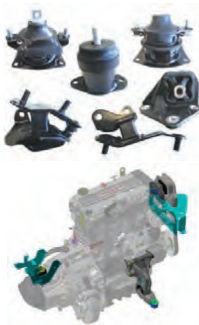
شکل ۶-۹- محل بستن دسته‌موتور
