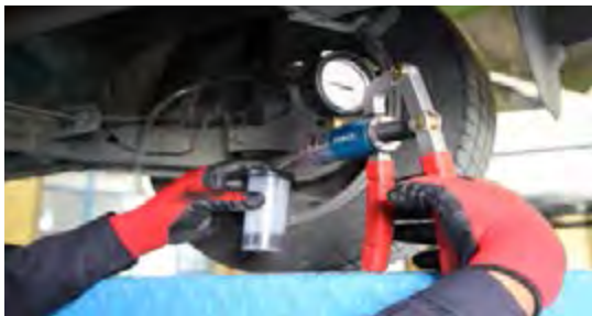
شکل ۱۲-۶- نمونه‌ای از دستگاه خلأیی هواگیری سیستم ترمز
