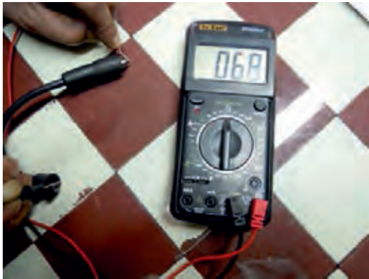
شکل ۳۸-۸- آزمایش اهمی وایر شمع
