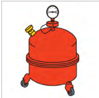
شکل ۱۴-۶- عوض کردن و هواگیری سیستم هیدرولیک ترمز با دستگاه تزریق تحت فشار
