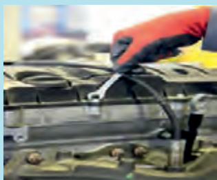
شکل ۲۲-۱- استفاده از آچار نامناسب
