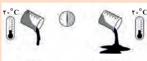
شکل ۳-۳- دو نوع سیال متفاوت در دمای یکسان
