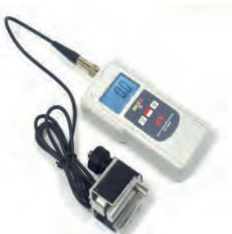
شکل ۴۰-۸- دستگاه کشش سنج تسمه تایم
