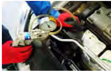
۲ مخزن را پر کرده و پمپ با تبدیل مناسب روی در مخزن بسته شود.
