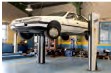
۲ پس از رسیدن موتور به دمای کاری، آن را با رعایت ایمنی روی چاله سرویس و یا جک بالا بر قرار دهید.
