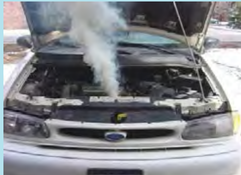
شکل ۱۷-۷- پاشش آب رادیاتور
