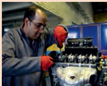
شکل ۲۸-۸- تنظیم پیچ و مهره‌ای خلاصی سوپاپ‌ها
