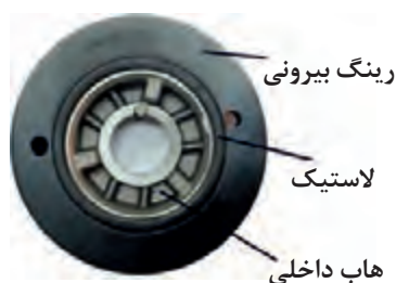
شکل ۹-۲. پولی نوسانگیر (منجیددار)
