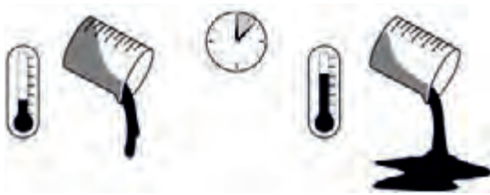
شکل ۲-۳- تأثیر دما بر گرانروی روغن
