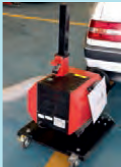
شکل ۲۰-۸- استفاده از دستگاه آگزوز فن
