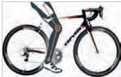
شکل ۱-۲- انتقال توان در دوچرخه
