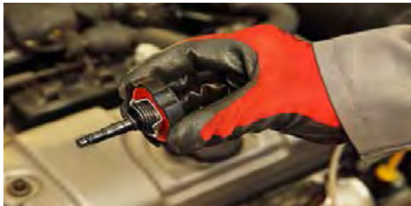
شکل ۷-۵ - شاخص‌های روی درپوش مخزن مایع هیدرولیک فرمان
