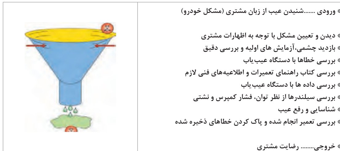
شکل ۱۱-۸- مراحل هشتگانه عیب‌یابی
