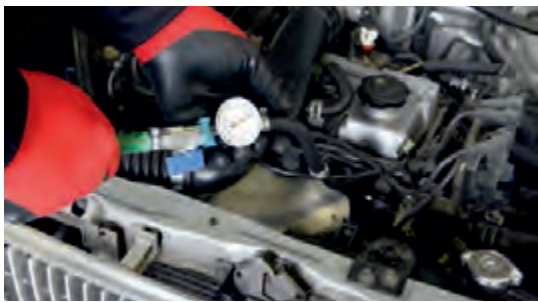
۴ هوای فشرده به سیلندر تزریق شود و پس از بستن شیرمانومتر به افت فشار عقربه دقت کرده و در صورت افت فشار مرحله ۵ انجام شود.
