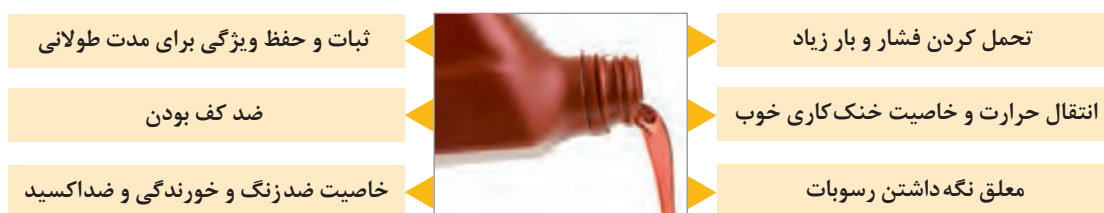
شکل ۴-۲- ویژگی‌های اصلی روغن جعبه‌دنده
