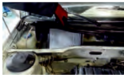
۳ فیلتر نو با دقت و به شکل درست، در محفظه خود قرار گیرد.
