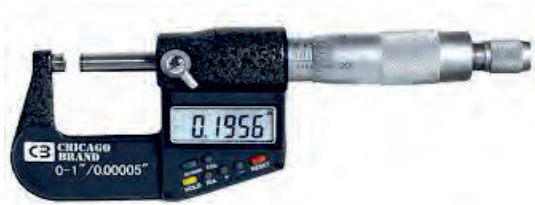
شکل ۲۹-۸- میکرومتر خارج سنجی
