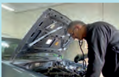
شکل ۱۹-۲- استفاده از گوشی مکانیکی
