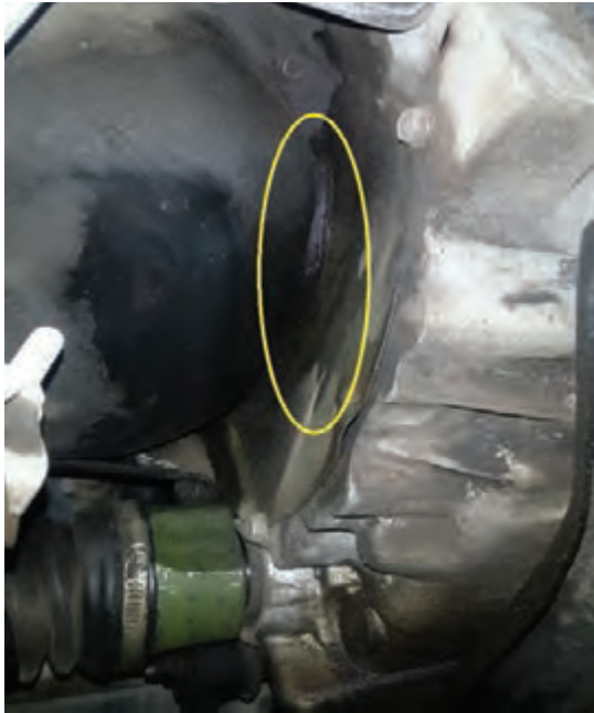
شکل ۴-۶- قرار گرفتن خودرو روی جک بالا بر و دیدن محل های احتمالی نشتی
