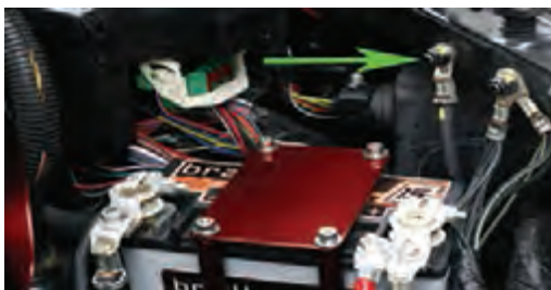
شکل ۱۱-۹- اتصال منفی یا اتصال بدنه قسمت موتور
