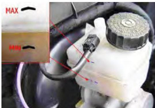
شکل ۵-۶- بررسی سطح مایع هیدرولیک ترمز
