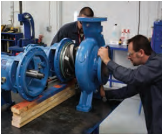
شکل ۲- تعمیر اساسی پمپ در کارگاه مکانیک
