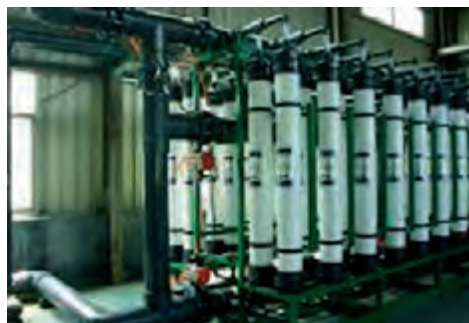
شکل ۱۰- نمایی ساده و واقعی از فرایند اولترافیلتراسیون
