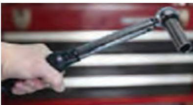
شکل ۲۴- آچار ترک یا آچار گشتاور
