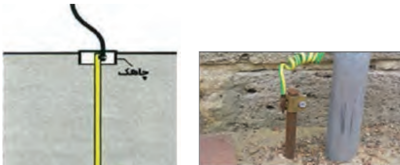
شکل ۴ - شیوه اتصال به چاه ارت
