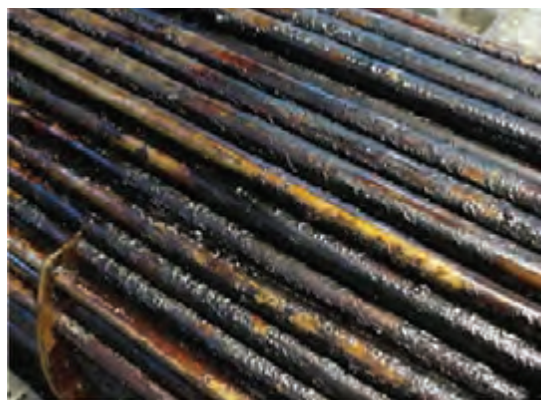
شکل ۳۲- رسوبات ناشی از تخریب روغن و خوردگی قطعات
