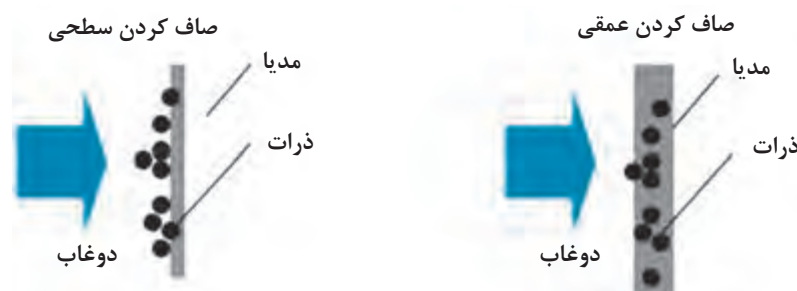
شکل ۶- انواع فیلتراسیون (بر حسب چگونگی حرکت سیال)
