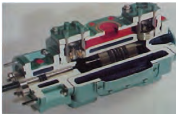
شکل ۲۵- نمای داخلی یک کمپرسور
