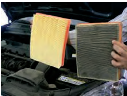
شکل ۲۲ - فیلتر هوای تمیز و کار کرده
