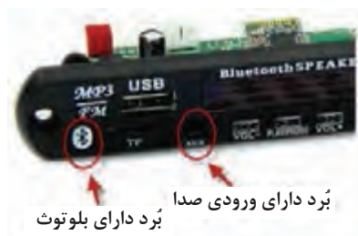
شکل ۵-۷- بُرد دارای بلوتوث و ورودی صدا
