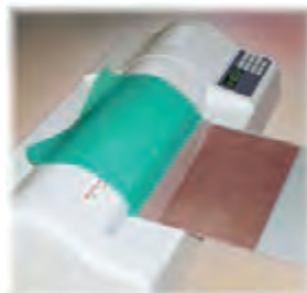
شکل ۳-۱۵- ورود فیبر به لمینتور
