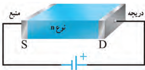
شکل ۴-۱۷- نیمه‌هادی با ناخالصی N به عنوان کانال
