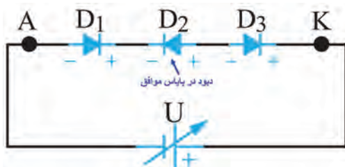
شکل ۷-۵ دیود چهار لایه در بایاس مخالف
