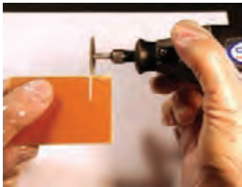
شکل ۸-۳- بریدن فیبر با مینی‌فرز
