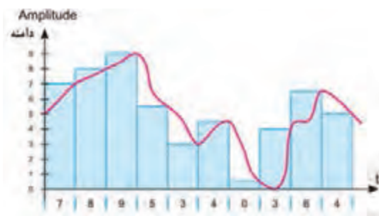
شکل ۶-۷۰ نمونه‌برداری از سیگنال آنالوگ
