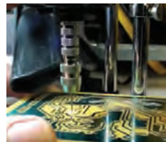
شکل ۳-۲۹- سوراخ کاری فیبر مدار چاپی
