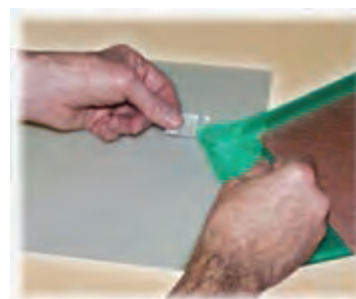
شکل ۳-۱۱- جدا کردن روکش لمینت
