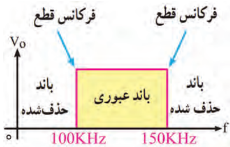
شکل ۵-۶ منحنی پاسخ فرکانسی فیلتر ایده‌آل
