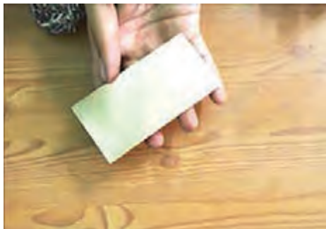
شکل ۳-۱۰- فیبر مسی تمیز شده
