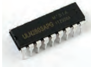
شکل ۴-۱۳- زوج دارلینگتون در یک بسته‌بندی و در یک آرایه
