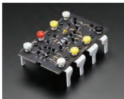
شکل ۴-۵۴- مدار داخلی آی سی ۷۴۱ با قطعات مجزا
