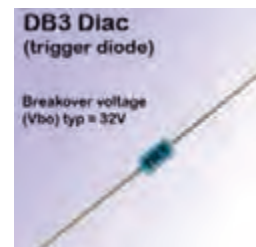
شکل ۷-۴۱ بخشی از برگه اطلاعات یک نوع دیاک
