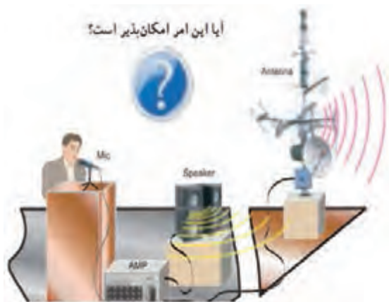
شکل ۶-۴۷ تبدیل امواج صوتی به امواج الکترومغناطیس
