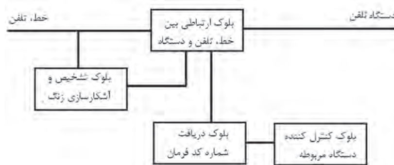
شکل ۶-۷۹ بلوک دیاگرام مدار
