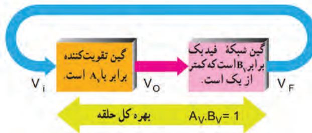
شکل ۶-۳۰ بررسی اصل بارک‌هاوزن
