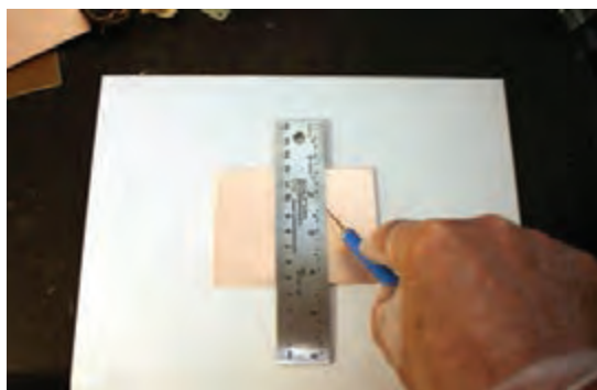
شکل ۳-۳- سوزن خط کش و روش استفاده از آن
