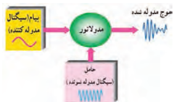
شکل ۶-۴۸ بلوک دیاگرام نحوه انجام مدولاسیون
