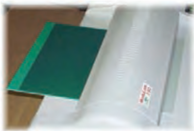
شکل ۳-۱۶- خروج فیبر از لمینتور
