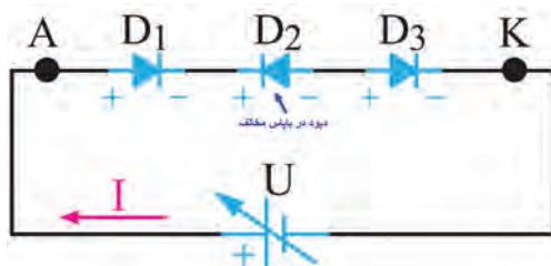
شکل ۷-۴ دیود چهار لایه در بایاس موافق
