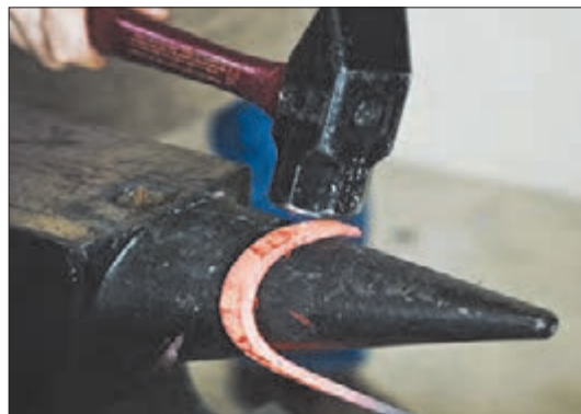
شکل ۳-۴- خمکاری دستی به کمک قالب و چکش
