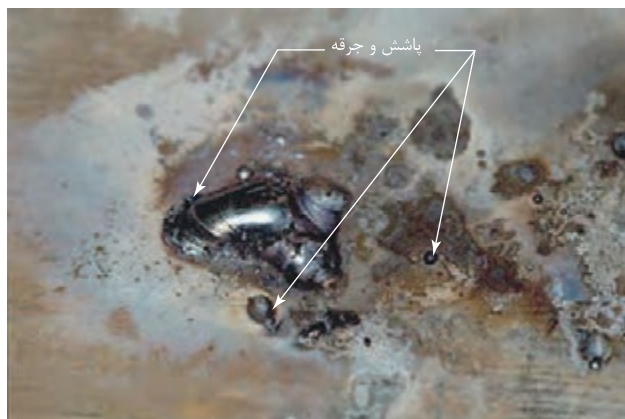
شکل ۴-۳۵: پاشش سخت شده بر روی فلز پایه
