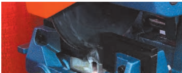
شکل ۱-۱۹- برشکاری با اره آب صابونی
