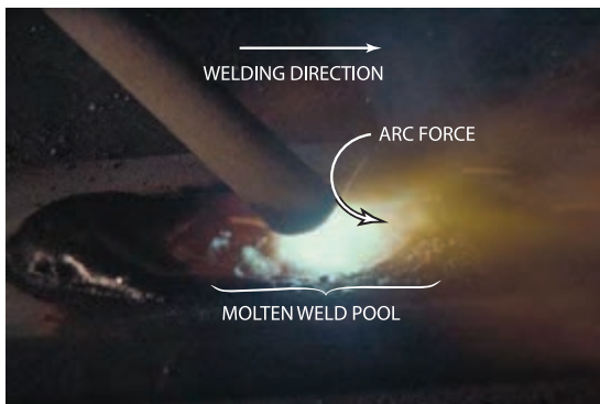
شکل ۴-۴۸- جوشکاری با زاویه پیشران
