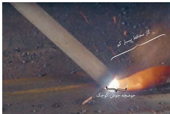
شکل ۴-۳۳- جوشکاری با آمپر بسیار پایین
