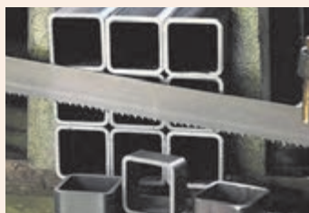
شکل ۱-۱۸- سری بری با استفاده از اره لنگ
