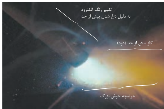
شکل ۴-۳۴- جوشکاری با آمپر بسیار بالا
