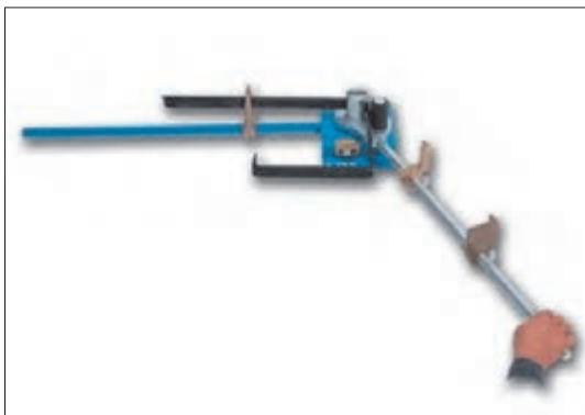
شکل ۳-۵- خمکاری دستی تسمه با ابزار کمکی
