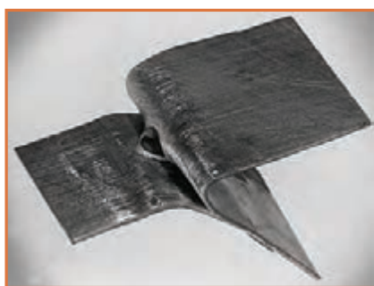
شکل ۱۹- نتیجه مطلوب در آزمون خم‌کاری
