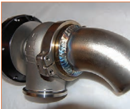
الف - جوش کاری دو قطعه فولادی
