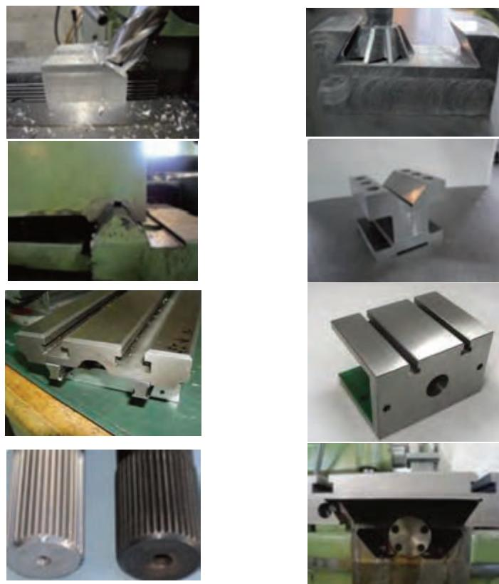
شکل ۳-۱۶: نمونه‌هایی از سطوح زاویه‌ای و شیارهای متنوع
