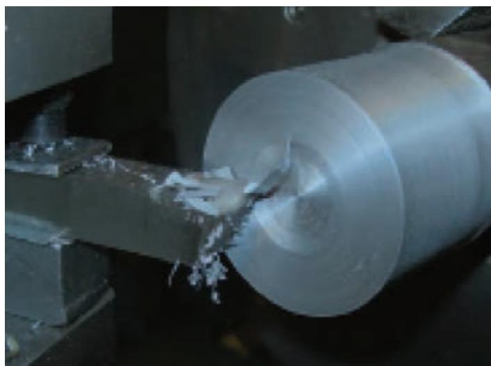
شکل ۲۹-۲: تراشکاری قطعات کوتاه
