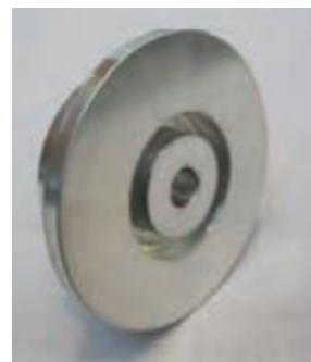
شکل ۳۴-۲: نمونه کار شیارتراشی
