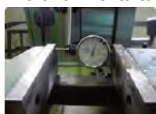
تنظیم گیره به کمک ساعت اندازه‌گیری
