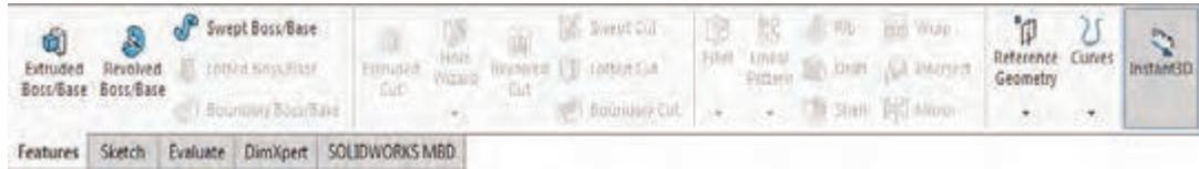
این دستورها برای ایجاد حجم به کار می‌رود. برای استفاده از این دستورها ممکن است نیاز به ترسیم دو بعدی ضروری یا اختیاری باشد. برای برخی از دستورها نیز نیاز به ترسیمات دو بعدی نیست، ولی حتماً برای اجرای آنها باید یک حجم سه‌بعدی وجود داشته باشد.
