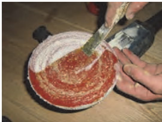
شکل ۱۷۷- چسباندن کاغذ سنباده به سنباده دیسکی
