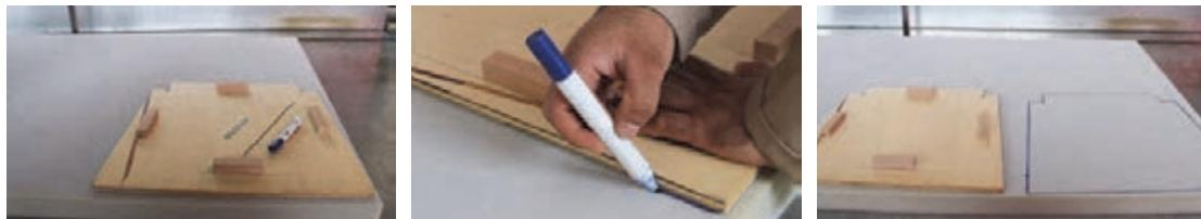
شکل ۳-اندازه گیری و خط کشی کفی صندلی
