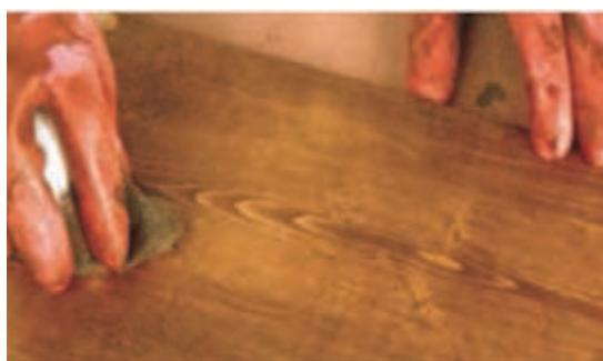
شکل ۱۴۴- زدن آستری همرنگی با پارچه
