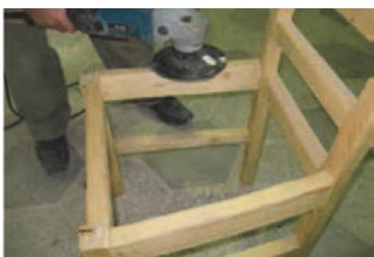
شکل ۷۲- پرداخت کاری قبل از بتونه
