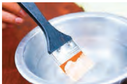
شکل ۳- شستن قلم‌مو با حلال به روش صحیح
