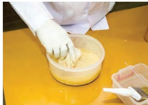
شکل ۱۴۵- استفاده از پارچه در لاق و الكل کاری
