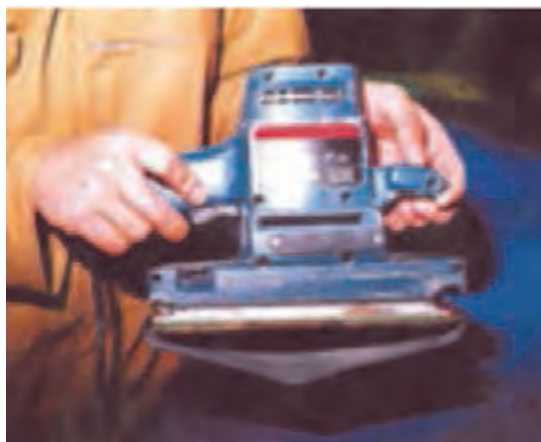
شکل ۴۷- شل شدن کاغذ سنباده
