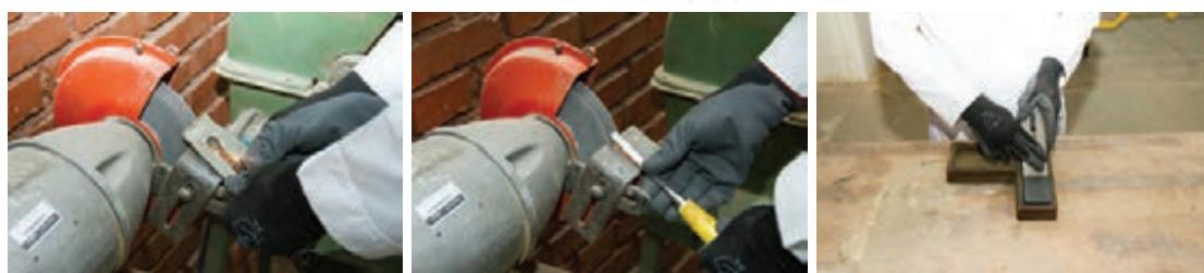
شکل ۳- تیز کردن تیغه رنده به صورت اصولی
