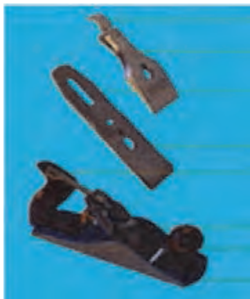
شکل ۱۲۸- رنده آهنی و تیغه های آن
