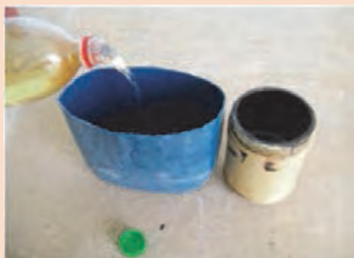
شکل ۸- اضافه کردن نفت به آستری قیری
