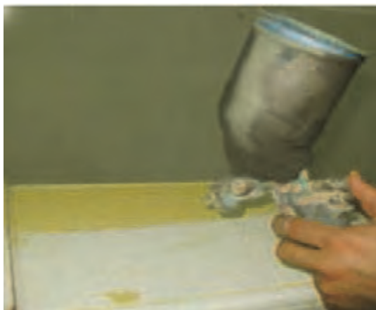
شکل ۲۹- پاشیدن رنگ نیترو سلولزی با پیستوله
