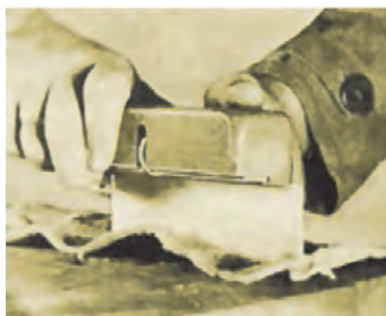
شکل ۶۲- مصقل کشی در لیسسه با رنده مصقل
