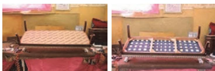
شکل ۳۹-پوشش کف مبل با متقال
