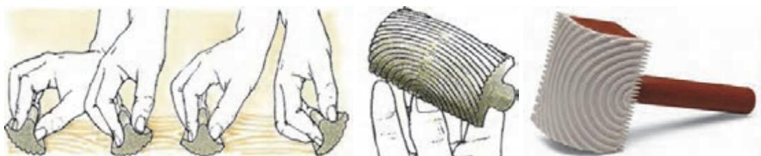
شکل ۱۶۰- روش صحیح استفاده از نقش‌انداز
