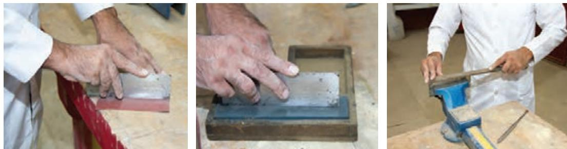
شکل ۱۱۸- سوهان کشیدن روی نر لیسه شکل ۱۱۹- کشیدن لیسه روی سنگ نفت شکل ۱۲۰- کشیدن لبه لیسه به سنباده
