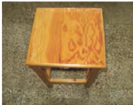
شکل ۲۷- اثر بتونه روی صفحه چهارپایه کاملاً نمایان است.
