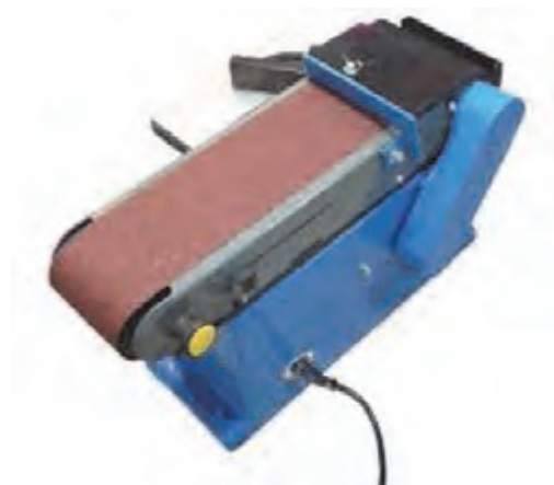
شکل ۵۲- با این پیچ می‌توان غلطک را حرکت داد
