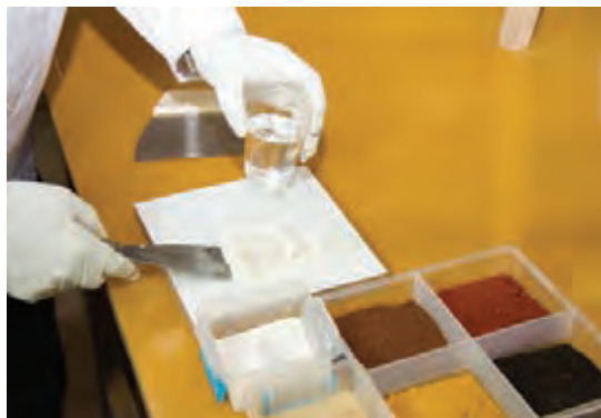
شکل ۷۰- اضافه کردن آب به بتونه
