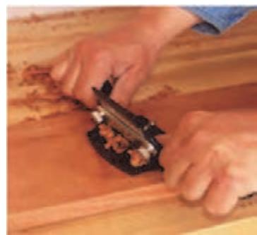
شکل ۱۱۹- پرداخت کاری روی چوب
