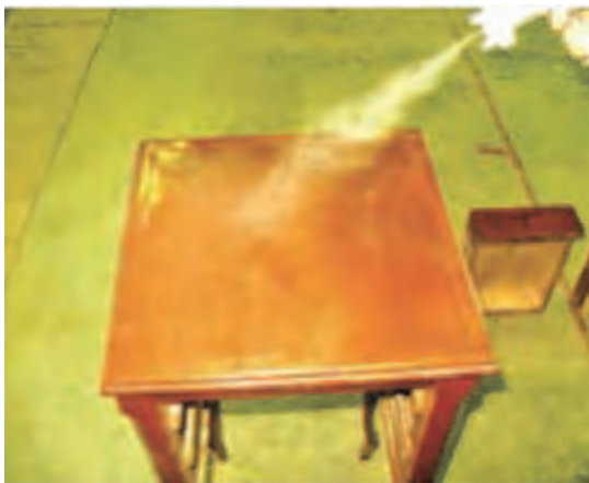
شکل ۲۸- چهارپایه رنگ شده با رنگ نیترو سلولزی
