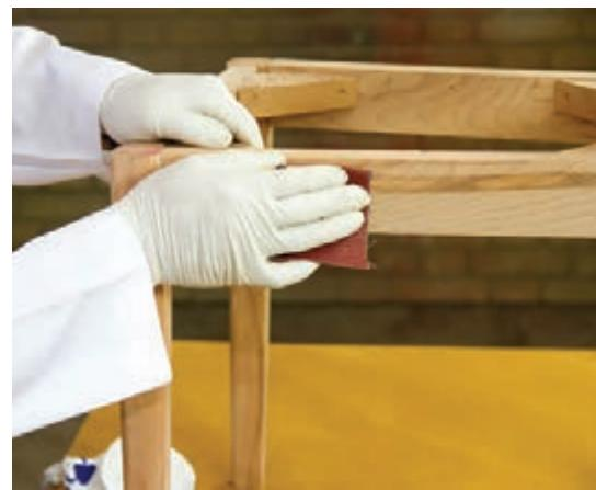
شکل ۱۲- سنباده کاری در جهت الیاف
