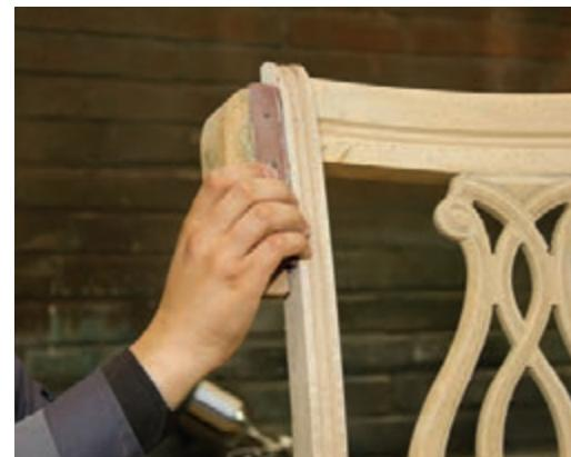
شکل ۹- سنباده کاری به کمک تخته پوست
