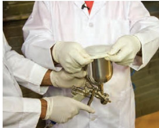
شکل ۱۸- استفاده از تنظیف برای صافی
