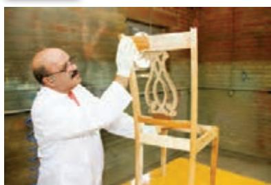
شکل ۵۹-زدن روغن بزرک با کهنه
