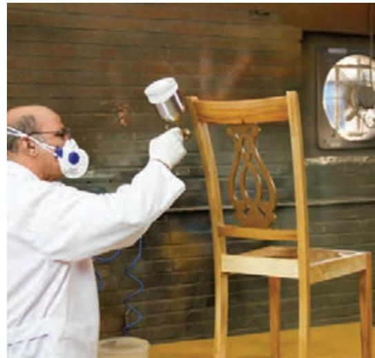
شکل ۴۳- زدن پلی استر با پیستوله
