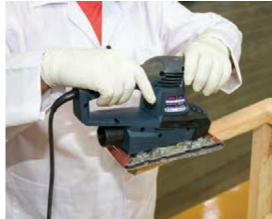
شکل ۴۶- سنباده کاری در جهت الیاف
