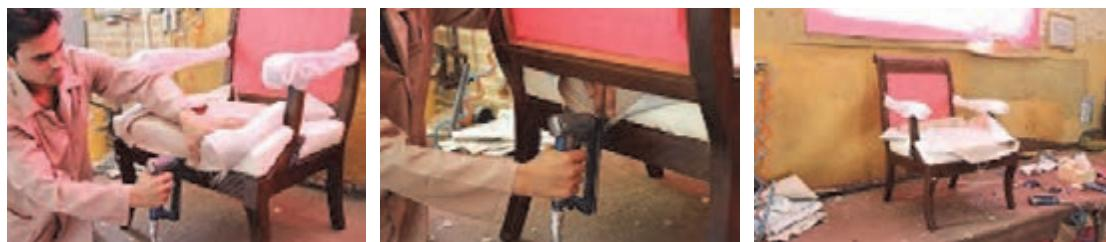
شکل ۳۶- کوبیدن پارچه کف میل
