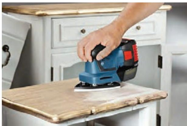
شکل ۳۳- فشار یکنواخت به سطح کار
