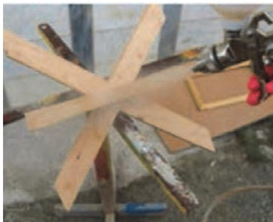
شکل ۴۰- زدن کیلر به کار با پیستوله
