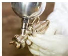
شکل ۱۷۲- پیچ تنظیم هوا
