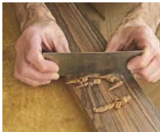
شکل ۵۵ - لیسه کشی در جهت الیاف
