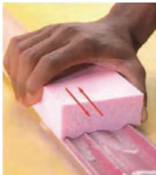
شکل ۱۰۸- تخته سنباده برای قطعه افزار خورده
