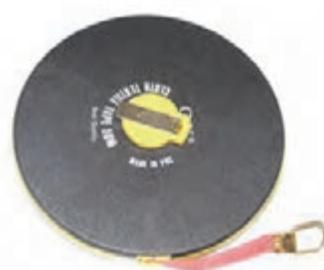
شکل ۳۸- متر نوار فلزی
