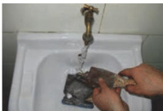
شکل ۱۴۰- شستن و تمیز کردن لیسه و کاردک
