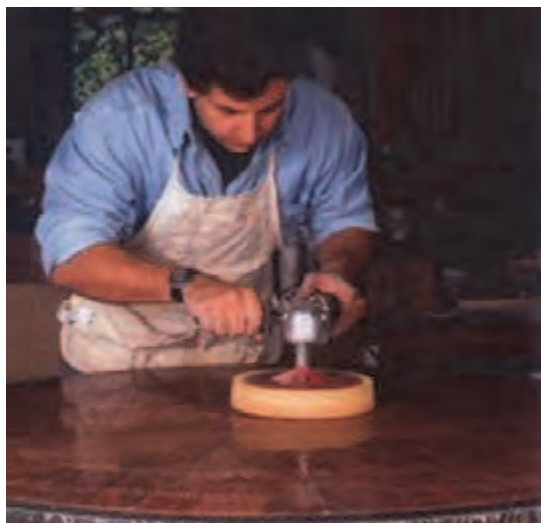
شکل ۴۷- پولیش کاری سطح پلی‌استر خورده
