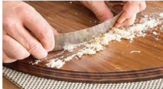
شکل ۱- استفاده از لیسه برای برداشتن مواد اضافی
