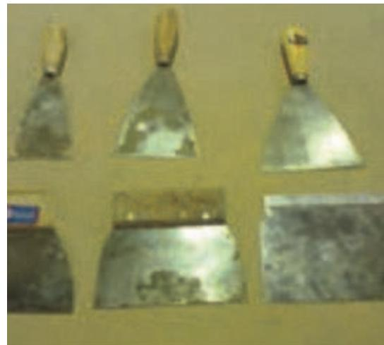
شکل ۱۳۷- چند نمونه لیسه و کاردک
