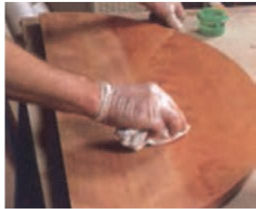
شکل ۵۷—استفاده از پارچه نمدادار در لیسه کاری
