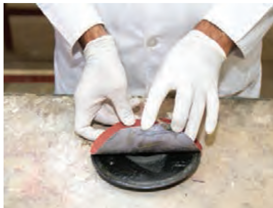
شکل ۱۷۶- چسب زدن به کاغذ سنباده
