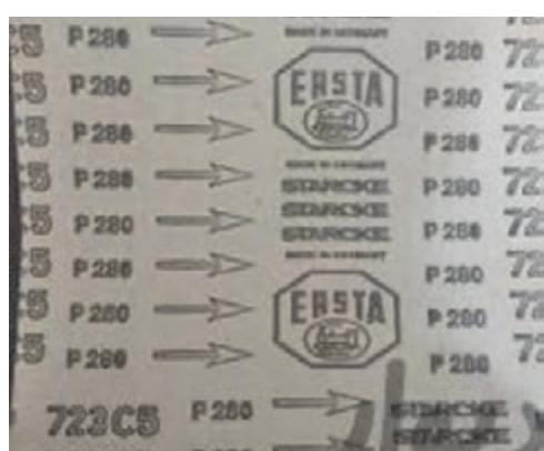
شکل ۵۱—به جهت فلش ورق سنباذه توجه کنید.
