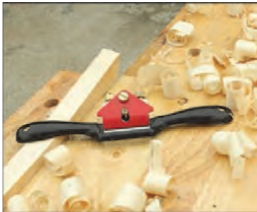
شکل ۵۸- نصب لیسسه به رنده بال کبوتری
