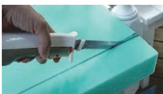
سرد یا گرم استفاده می‌شود. یک ابر  $2$  سانتی‌متری بر روی کار کشیده می‌شود. ابر موردنظر باید از هر طرف  $1$  سانتی‌متر بزرگ‌تر باشد تا به صورت دو لایه روی ضخامت مبل کوبیده شود. معمولاً ابر از لب کلاف مبل کمی بیرون می‌زند (شکل ۳۵).
