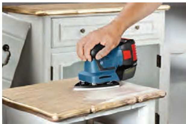
شکل ۳۳- فشار یکنواخت به سطح کار
