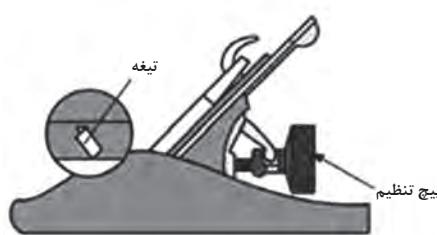
شکل ۶- پیچ تنظیم رنده
