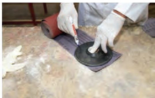
شکل ۲۹- ترسیم گردی دیسک روی سنباده
