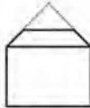
اگر مکعب درست روبه‌روی چشم قرار داشته باشد (پرسپکتیو با یک نقطه گریز)
