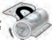
(ت) انتقال تصویر از تونر به کاغذ
