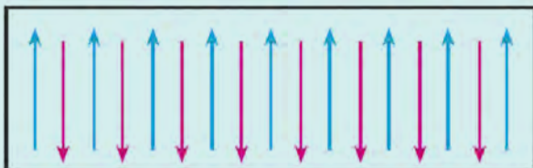
یک حوزه مربوط به ماده پادفرومغناطیس، در مواد پادفرومغناطیس برآیند گشتاورهای مغناطیسی در هر شبکه صفر است.
