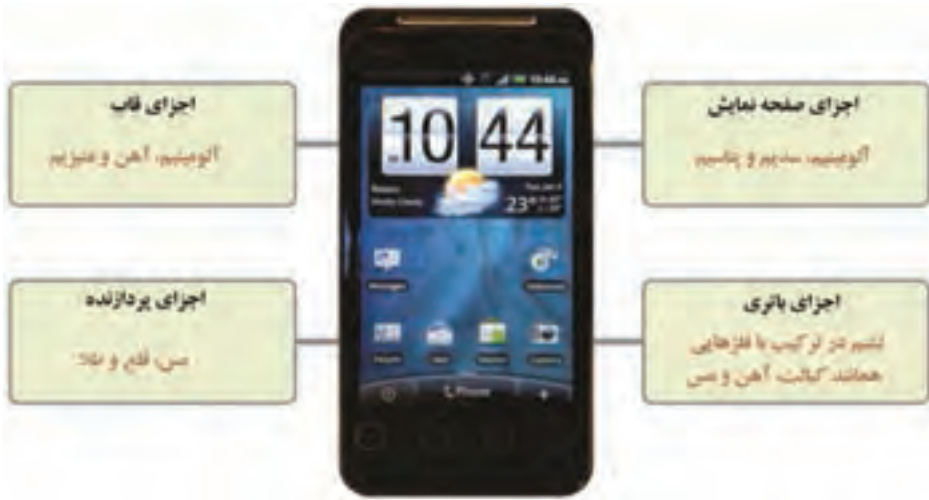
شکل ۲۲- فلزهای به‌کار رفته در چهار قسمت مختلف تلفن همراه
