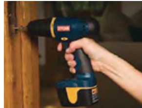
باتری Ni-Cd در دریل برقی قابل شارژ
