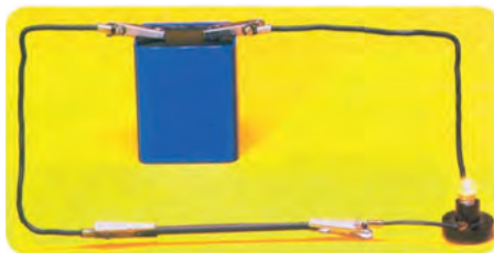
شکل ۳۵- مدار بررسی‌کننده هدایت الکتریکی مواد
