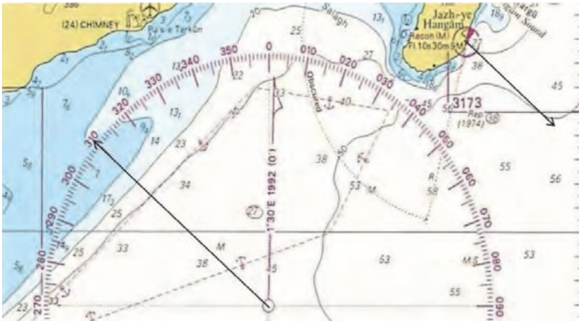
شکل ۵- روش ترسیم سمت یک شیء روی نقشه
