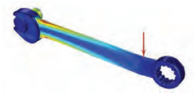
شکل ۵-۱۲- قسمت‌های بحرانی یک آچار هنگام بارگذاری
