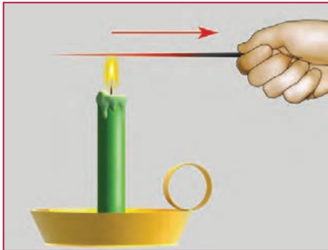
شکل ۲۱-۲- آزمایش هدایت حرارتی با میله فلزی و شعله شمع
