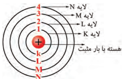
شکل (۲-۴) مدل اتمی بور و لایه های الکترونی
