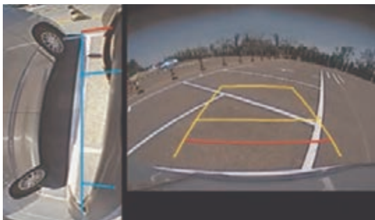
شکل ۱۲- نمای عقب با خطوط راهنما و دید جانبی در مسیر حرکت
