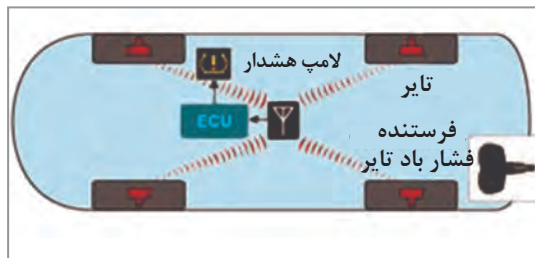
شکل ۲۹- تشخیص فشار مطلق هوا و استفاده از فرستنده برای ارسال اطلاعات شکل ۳۰- تشخیص فشار هوا از ظاهر و قطر مؤثر تایر
