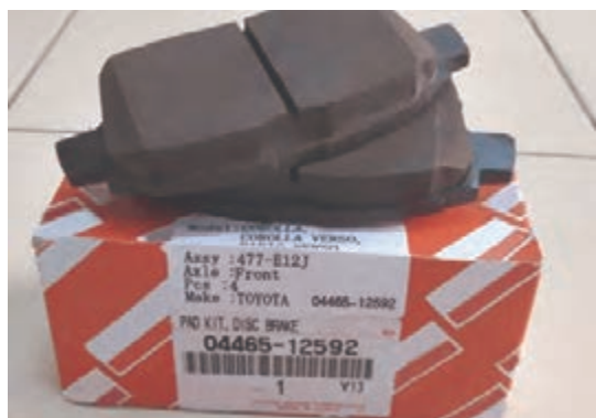
شکل ۶- نمونه‌ای از روش درج شماره فنی
