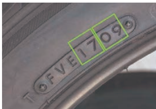
شکل ۷- محل نوشتن تاریخ تولید در برخی قطعات خودرو
