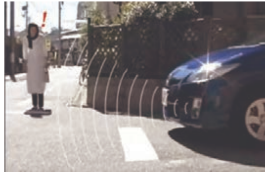
شکل ۴۵- سیستم صوتی نزدیک‌شونده خودرو
