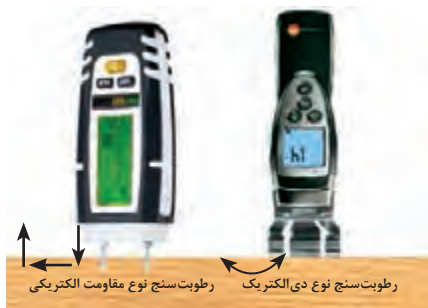
شکل ۸- روش کار رطوبت سنج های الکتریکی
