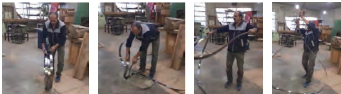
شکل ۱۹- روش جمع کردن تیغه اره نواری
