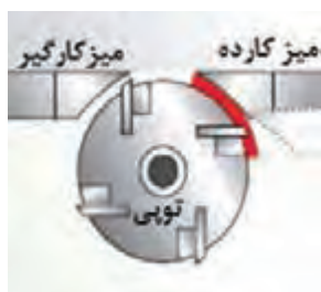
شکل ۲۶- موقعیت توپی رنده بین صفحات ورودی و خروجی ماشین رنده کف رند
