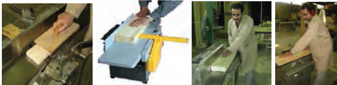
شکل ۲۹- نحوه رندیدن صحیح قطعه کار چوبی
