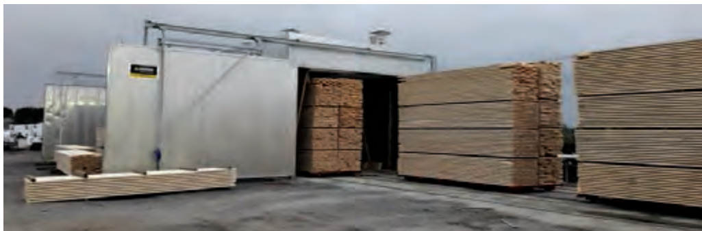
شکل ۶۵- بارگیری دسته‌بندی‌های چوب به طریق طولی
