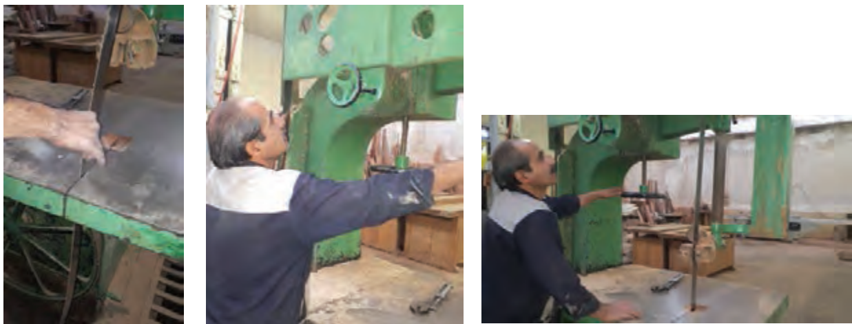
شکل ۱۷- خارج کردن تیغه از روی فلک‌های ماشین اره نواری
