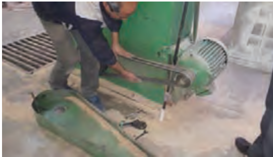
شکل ۵۹- روش باز کردن حفاظ و بررسی تسمه
