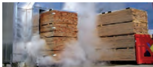
شکل ۶۴- اصول دسته‌بندی چوب روی واگن
