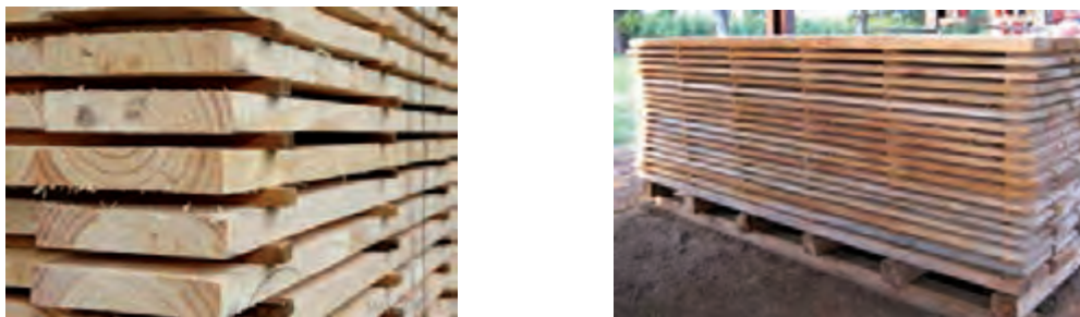
شکل ۱۳- روش چوب‌دستک‌گذاری در دسته‌های چوب
