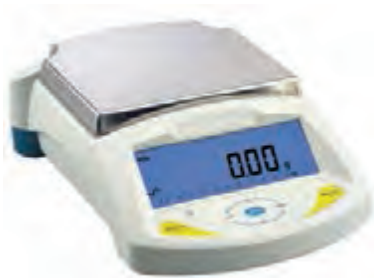
شکل ۳- وزن نمونه به وسیله ترازو با دقت ۰/۰۱ گرم
