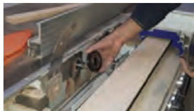
شکل ۶۲- باز کردن مهره و فلنج جلوی تیغه
