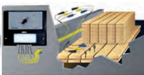
شکل ۵۸- نحوه قرار گرفتن الکتروود رطوبت‌سنج چوب در واحد دسته‌بندی
