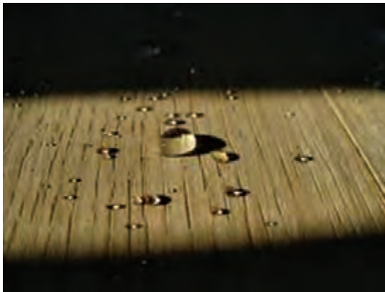
شکل ۷۲- نمونه چوب ضدآب شده با کمک نانوذرات
