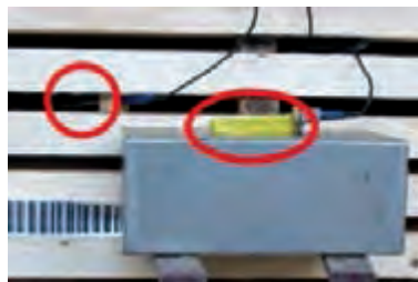
شکل ۵۷- اندازه‌گیری رطوبت نسبی و درجه حرارت درون کوره
