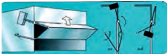
شکل ۳۳- در با حرکت عمودی برای کوره‌های بزرگ تا پهنا ۱۴ متر
