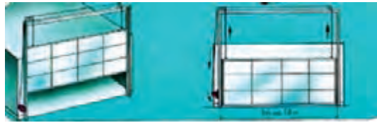
شکل ۳۳- در با حرکت عمودی برای کوره‌های بزرگ تا پهنا ۱۴ متر
