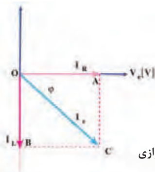
شکل ۹-۷- مدار RL موازی
