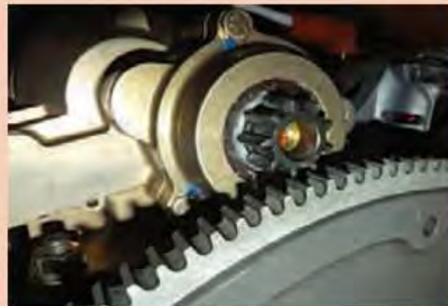
شکل ۱۰۰- ارتباط دنده فلایویل با دنده استارت
