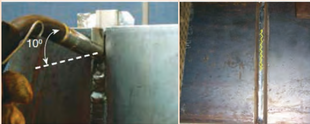
شکل ۲۴- زاویه تورچ و جهت حرکت آن
