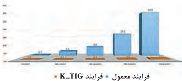
شکل ۱۶- نمودارهای مقایسه ای فرایند معمول TIG و فرایند K-TIG
