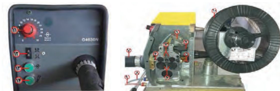
شکل ۱۵- اجزای منبع تغذیه سیم جوش
