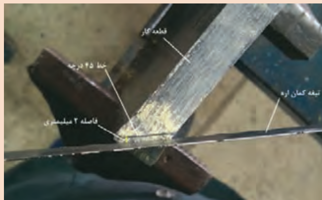
شکل ۱۶- الف) باقی گذاشتن مقداری از ضخامت ورق برای سوهان کاری ب) بررسی صحت زاویه پخ
