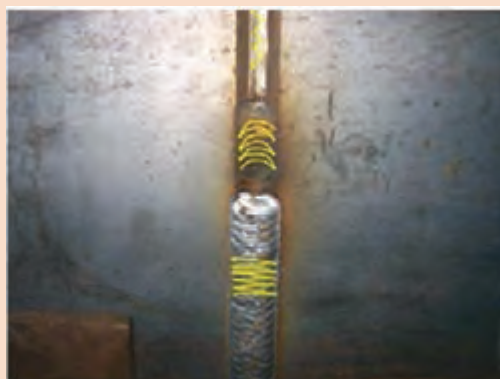
شکل ۲۶- زاویه تورچ و جهت حرکت آن برای انجام پاس سوم
