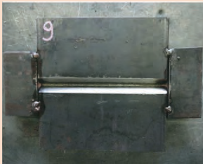
شکل ۲۱- موقعیت دهی و مونتاژ قطعه کار
