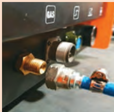
شکل ۶- نصب اتصال گاز محافظ
