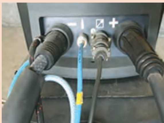
شکل ۹- کابل اتصال سوئیچی
