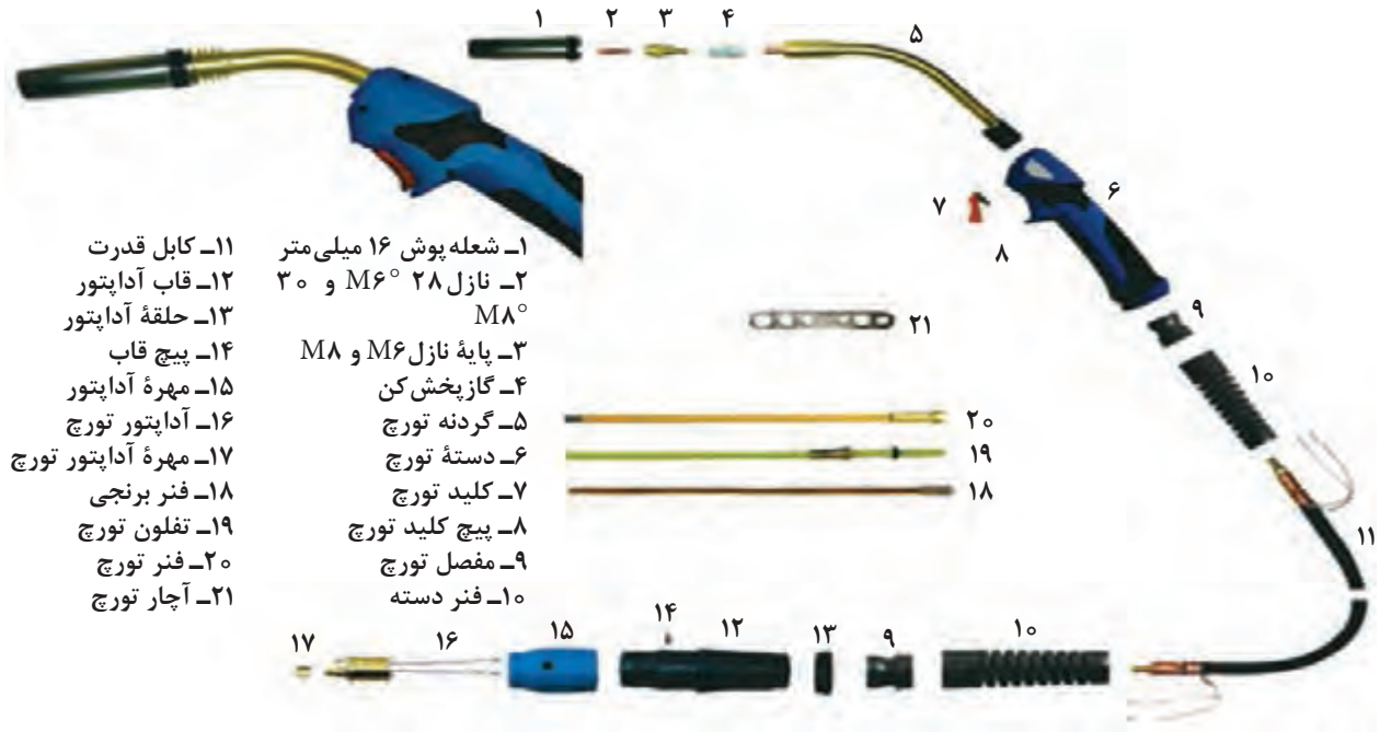
شکل ۷- اجزای تشکیل دهنده تورچ GMAW
