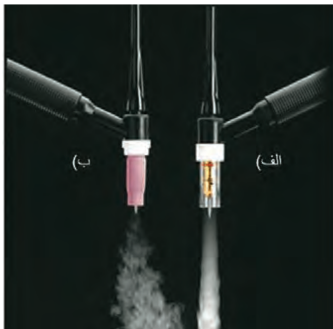
شکل ۱۴- لنز گازی در فرایند TIG
