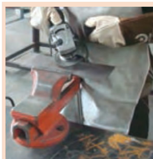
شکل ۱۲- سنگ زدن پشت ورق (ریشه جوش)
