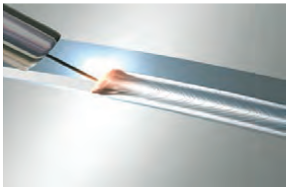
شکل ۴- قابلیت مشاهده حوضچه مذاب در فرایند GMAW
