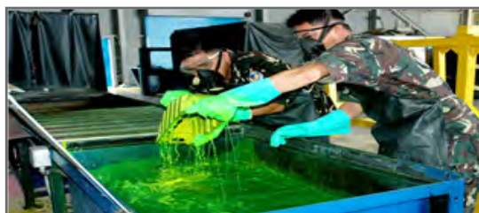
روش غوطه‌وری در مخزن مایع نافذ
