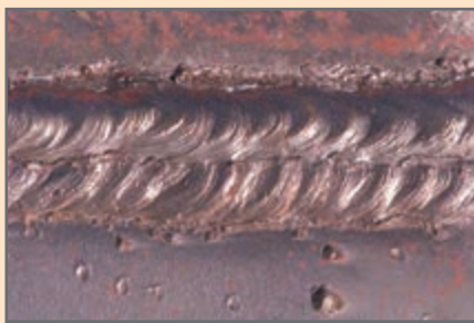
شکل ۴۰-۱- اندازه گرده جوش در پاس پوششی
