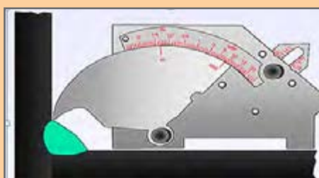
شکل ۱۲-۳- اندازه ساق جوش
