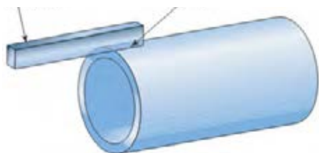
شکل ۲-۳۱- نگهداشتن لوله در حمل جوشکاری
