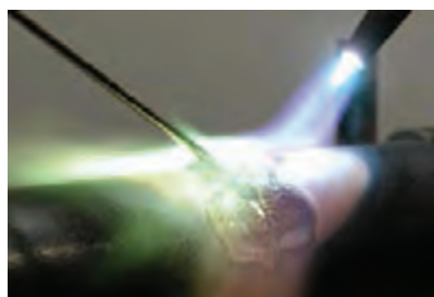
شکل ۳-۴-۱۴ استفاده از روان ساز در زردجوش
