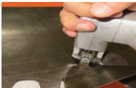
شکل ۱-۳۱- روش برش کاری با نیبلر دستی
