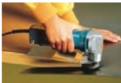
الف) نیبلر با نیروی محرکه الکتریکی ب) نیبلر با نیروی محرکه هوای فشرده (پنوماتیکی) شکل ۱-۲۴
