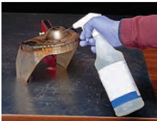
شکل ۴-۲۲- تمیزکاری بعد از جوشکاری توسط محلول شیمیایی
