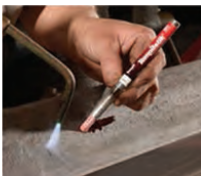
شکل ۴-۱۸- اندازه‌گیری دما توسط گچ‌های حرارتی
