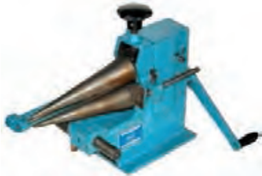
شکل ۲-۲۲ نورد خاص در تولید مخروط ناقص
