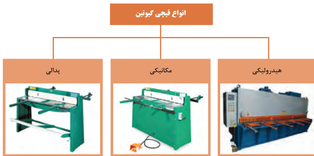
شکل ۳-۱- انواع گیوتین از نظر نحوه انتقال قدرت
