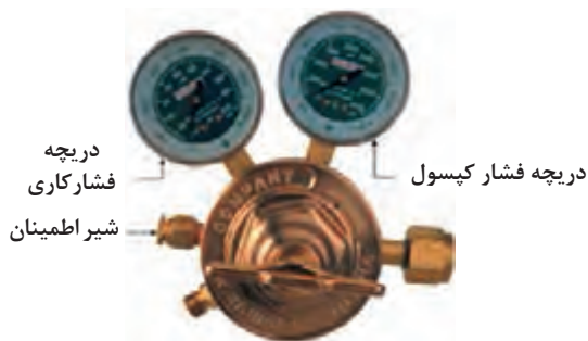
شکل ۳-۱۵- شیرهای اطمینان در رگولاتور اکسیژن
