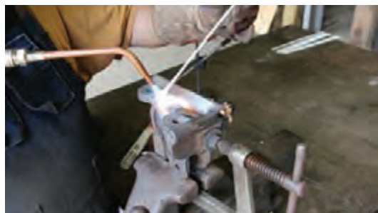
شکل ۴-۱۵- فیکسچر مورد استفاده شده در فرایند زردجوش
