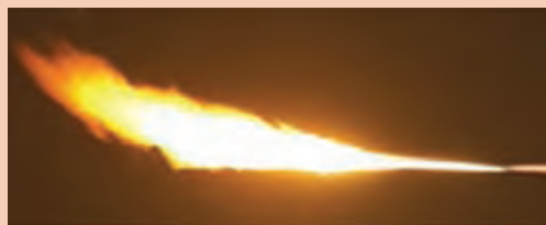
شکل ۳-۳۹- تنظیم شعله احیا (کربن ده)
