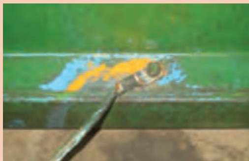
شکل ۱-۲۳- نمونه‌ای از سیم ارت در گیوتین
