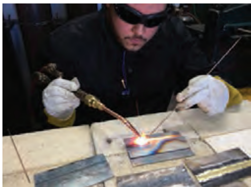
شکل ۴-۶- ذوب کردن فلز پایه و فلز پرکننده
