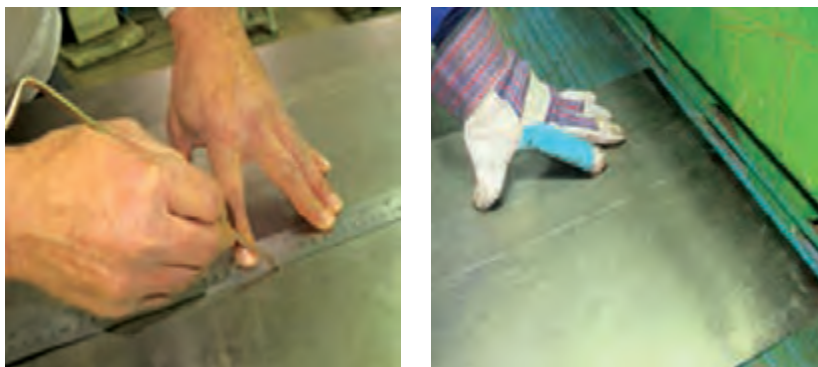
شکل ۱-۱۴- خط کشی و برش کاری ورق فولادی با گیوتین
