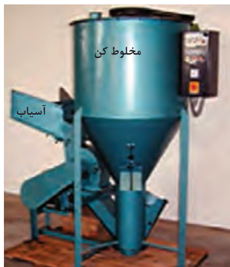
دستگاه آسیاب و مخلوط‌کن عمودی
