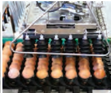
۲. انتقال تخم‌مرغ به شانه دستگاه ستر به روش نیمه خودکار
