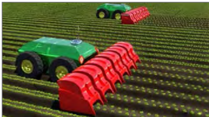
شکل ۱۷- ماشین تنک‌کننده کاهو
