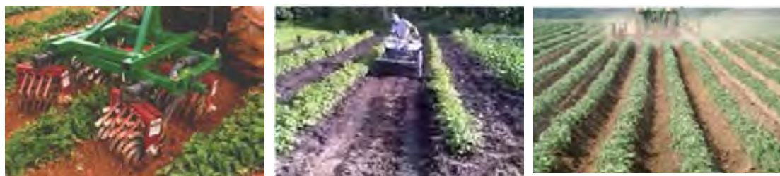
شکل ۷- خاک‌دهی پای بوته با مرکزکش دیسکی (بوته‌ها بین دو دیسک قرار می‌گیرند).
