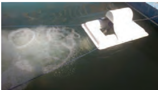
تأمین اکسیژن محلول در آب به‌وسیله دستگاه‌های هواده
