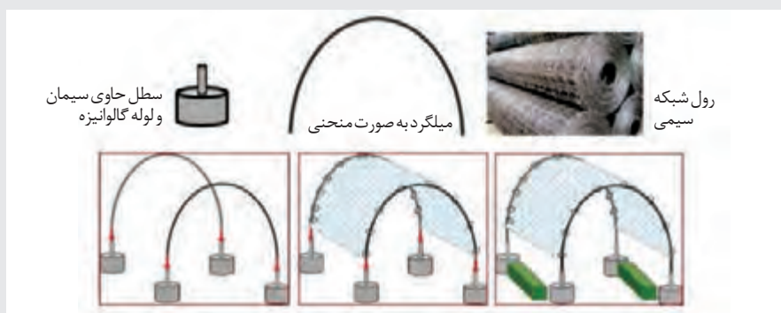
مراحل ساخت تونل سبز توسط شبکه‌های سیمی
