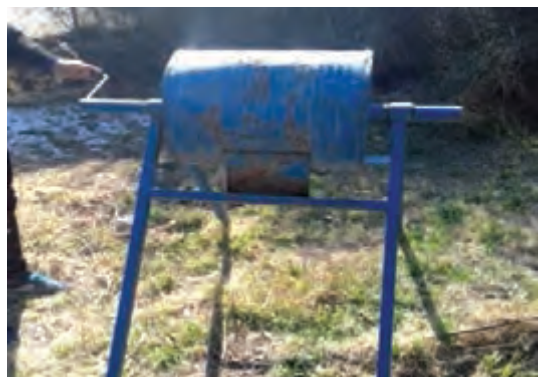
ماشین ضد عفونی کننده دستی و ماشین ضد عفونی کننده و پوشش دار کننده بذرها
