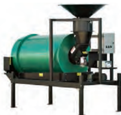
ماشین ضد عفونی کننده دستی و ماشین ضد عفونی کننده و پوشش دار کننده بذرها
