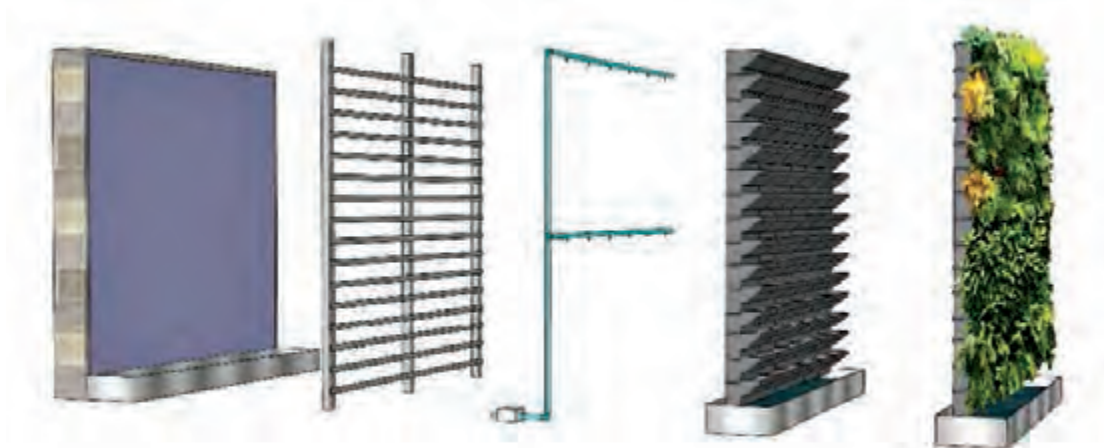
نحوه اتصال گلدان‌های کاشت روی شبکه‌های فلزی
