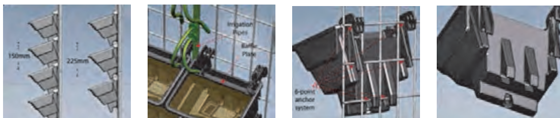
نحوه اتصال گلدان‌های کاشت روی شبکه‌های فلزی
