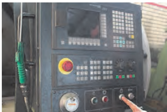
شکل ۱۹- روشن کردن سیستم هیدرولیک دستگاه
