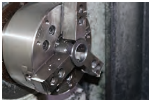
شکل ۹- استقرار سه‌نظام روی مجموعه محور اصلی
