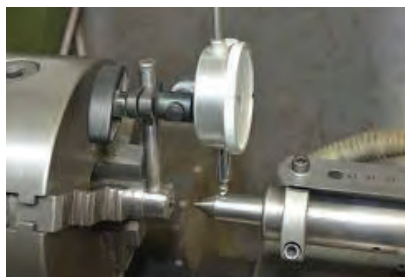
شکل ۳۰- اندازه‌گیری انحراف مرغک
