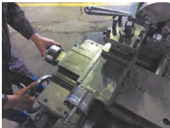
شکل ۱۰- حرکت همزمان سوپرت‌های دستگاه
