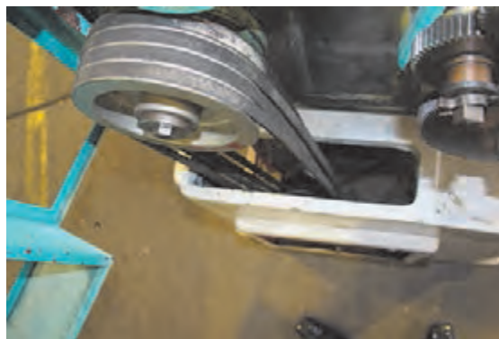
شکل ۳۵- اجزای انتقال حرکت از موتور به جعبه دنده اصلی
