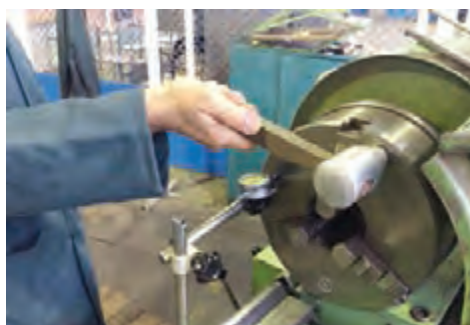
شکل ۷- اندازه‌گیری میزان لقی محوری
