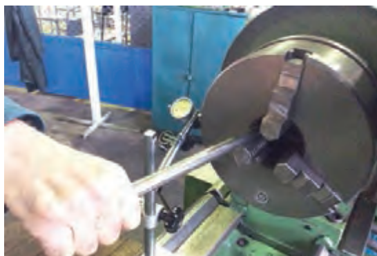
شکل ۳- اندازه‌گیری لقی شعاعی
