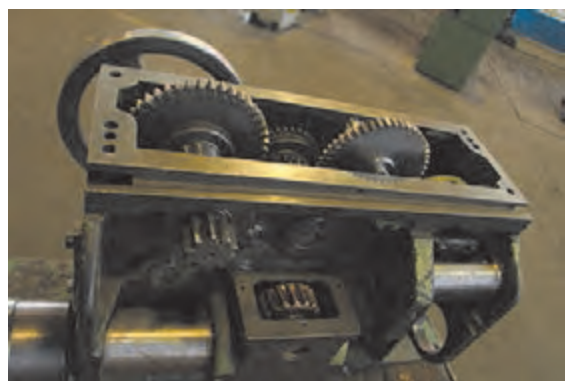
شکل ۱۵- درگیری چرخ‌دنده با دنده شانه‌ای
