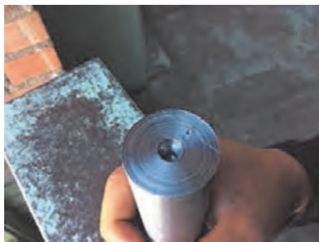
شکل ۲۲ - سنبه‌نشان‌زدن پیشانی قطعه کار
