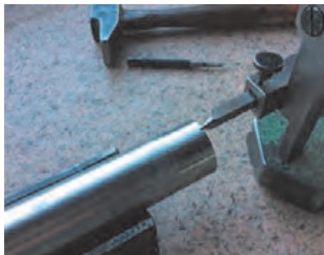
شکل ۲۱ - خط‌کشی و تعیین مراکز لنگ
