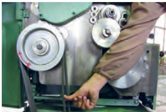
شکل ۳۵- اجزای انتقال حرکت از موتور به جعبه دنده اصلی
