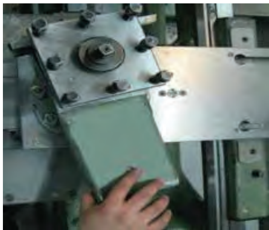
شکل ۱۲- مخروط تراشی به روش انحراف سوپرت بالایی
