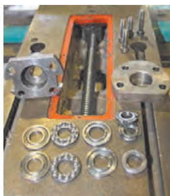
شکل ۹- یاتاقان‌بندی پیچ هادی محور عرضی
