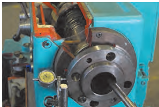
شکل ۳- اندازه‌گیری لقی شعاعی
