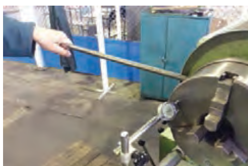
شکل ۷- اندازه‌گیری میزان لقی محوری
