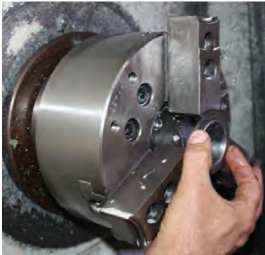
شکل ۳۰- بستن قطعه کار روی سه نظام
