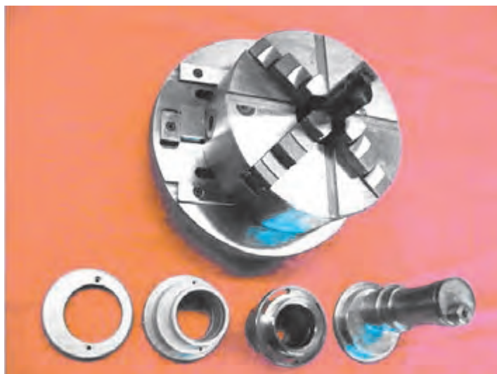
شکل ۱۷- سه‌نظام قابل تنظیم و قطعات تولید شده
