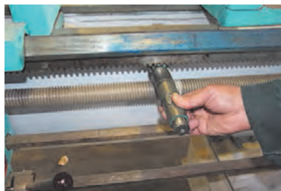
شکل ۱۵- درگیری چرخ‌دنده با دنده شانه‌ای
