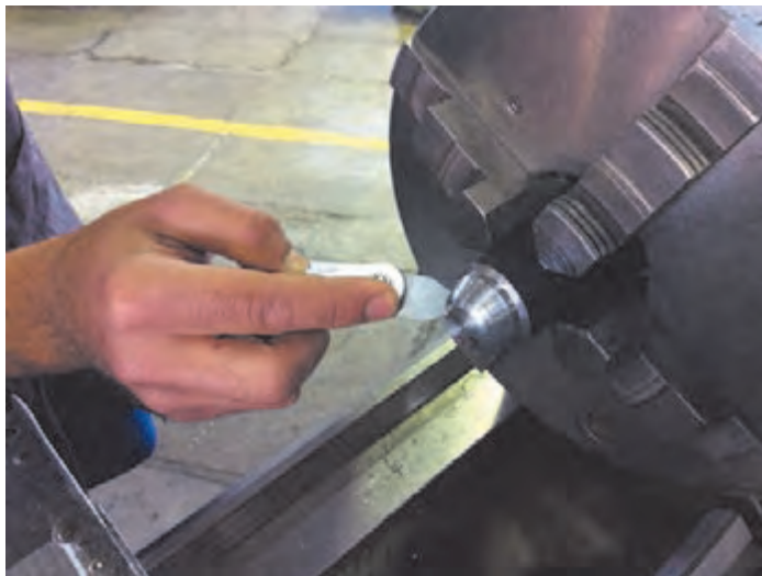
شکل ۱۲- کنترل فرم به وسیله شابلون
