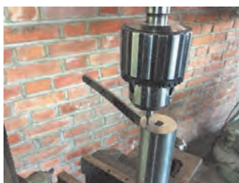
شکل ۲۳ - مته‌مرغک‌زنی به وسیله ماشین مته ستونی
