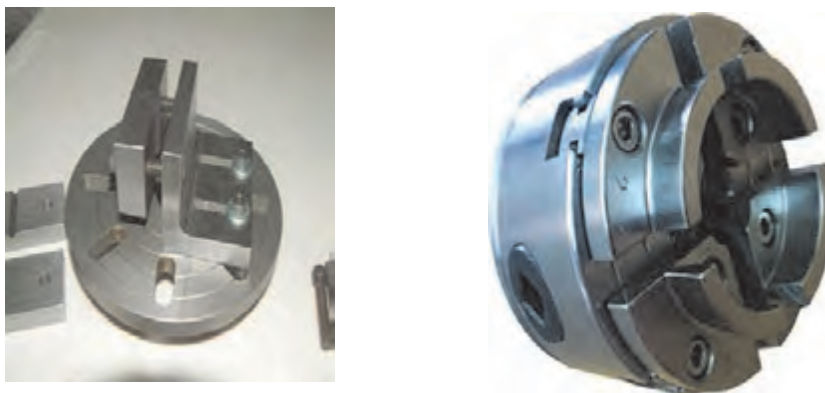
شکل ۱۹ - فیکسچرهای مخصوص لنگ تراشی
