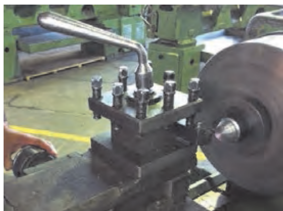
شکل ۱۰- حرکت همزمان سوپرت‌های دستگاه
