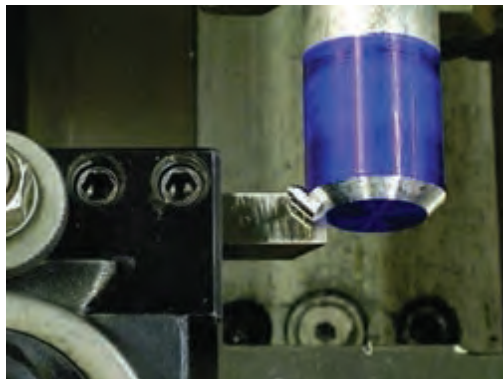
شکل ۱۸- مخروط تراشی به روش خاص
