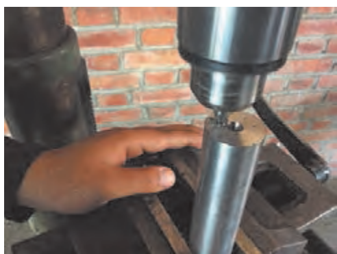
شکل ۲۳ - مته‌مرغک‌زنی به وسیله ماشین مته ستونی
