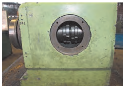
شکل ۵- سفت کردن یاتاقان جلوی دستگاه
