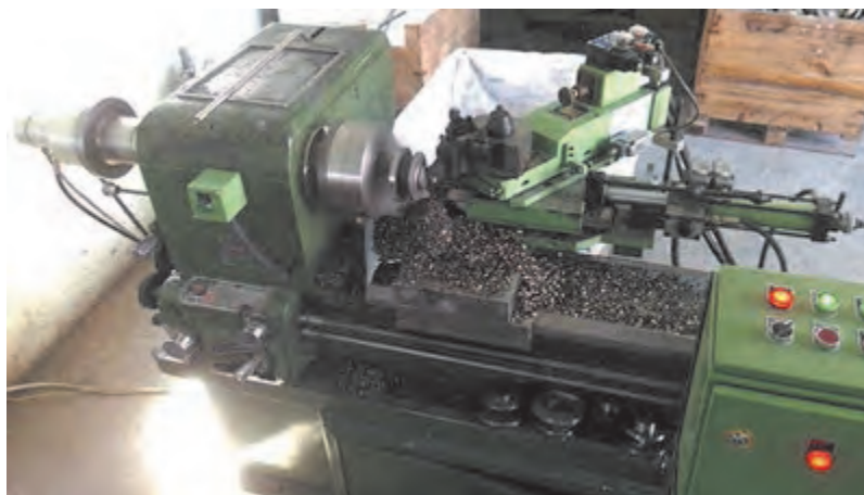
شکل ۷- عملیات کپی تراشی
