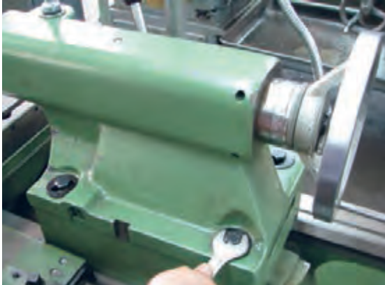
شکل ۲۸- سفت کردن پیچ‌های تثبیت
