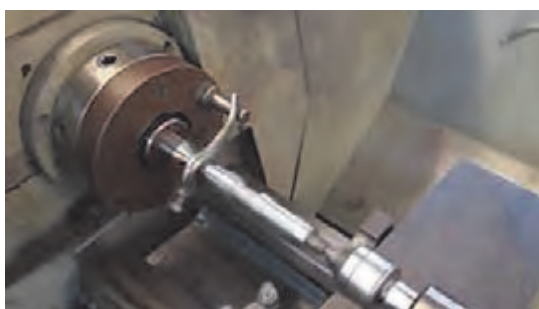
شکل ۲۰ - لنگ تراشی بین دو مرغک
