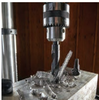
شکل ۳۰-۳- عملیات سوراخ کاری قبل از برقوکاری
