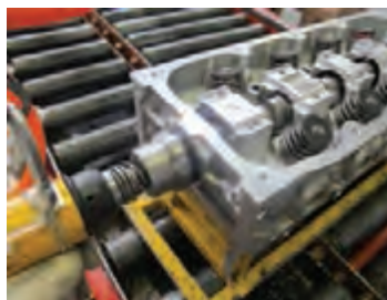
شکل ۵۵-۱ نحوه تعویض کاسه نمد میل سوپاپ با استفاده از ابزار مخصوص
