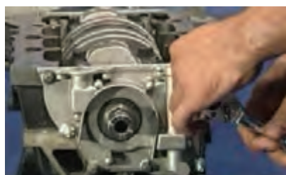
باز کردن پیچ های پمپ روغن
