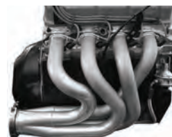
کنترل مانیفولد خروجی (فولادی)
