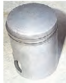
الف) پیستون قدیمی با وزن بیشتر
