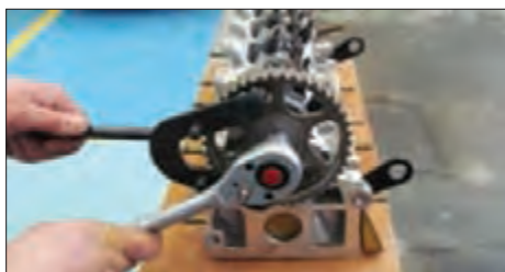
مراحل باز کردن چرخ تسمه
