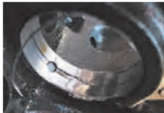
خرابی یاتاقان میل سوپاپ
