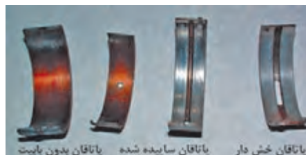
کنترل ساییدگی پیستون و یاتاقان‌ها و شماره روی شاتون
