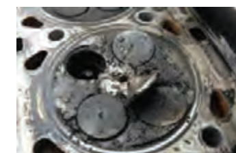
ذوب شدن سوپاپ
