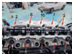
ترتیب باز کردن پیچ های سرسیلندر
