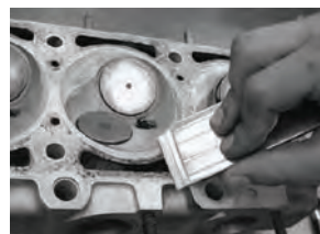
رسوب زدایی کف سرسیلندر و اتاق احتراق
