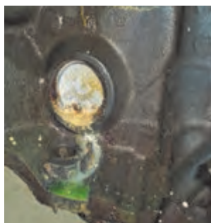
شکل ۱۰-۲ الف) نشستی از لوله‌ها و پولک اطراف سیلندر
