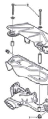
انفجاری سپرهای حرارتی و مانیفولد دود
