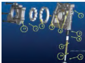
باز کردن اجزای پمپ و سوپاپ تنظیم فشار
