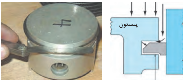
ب) کنترل خلاصی رینگ و پیستون نو
