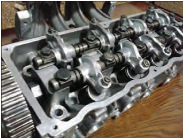
مجموعه اسبک غلتکی دارای پیچ و مهره تنظیم (موتور OHV - OHC)
