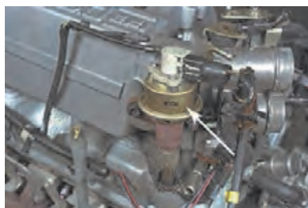
محل نصب EGR روی موتور خودرو
