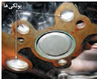
پولکی‌های نصب شده
