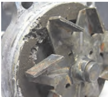
خرابی بلبرینگ و خوردگی داخلی
