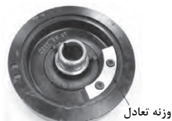
الف) اتصال وزنه بر روی پولی جهت بالانس شکل ۸۵-۲ (ب) چسباندن وزنه بر روی صفحه ارتعاشی جهت بالانس (فلاپویل)
