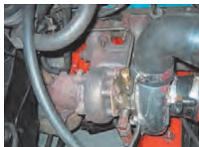
محل نصب توربو شارژر روی موتور
