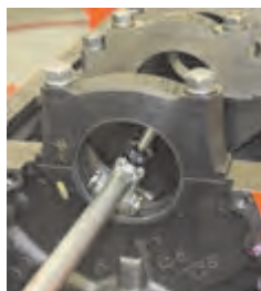
مرحله ۱: کالیبره کردن ساعت در داخل محفظه یاتاقان ثابت
