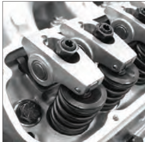
مجموعه اسبک های غلتکی در موتور OHV دارای تنظیم کننده هیدرولیکی ویاناقان رولبرینگی
