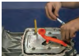
باز کردن صافی روغن ورودی به پمپ
