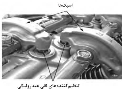
سرسیلندر دارای اسبک‌های تنظیم کننده هیدرولیکی
