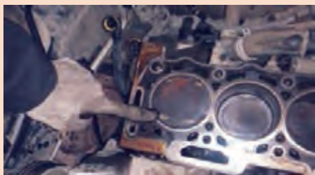
بر خورد سوپاپ‌ها به سر پیستون
