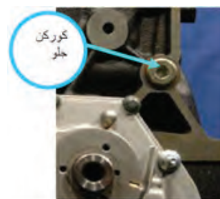
نصب پیچ‌های کورکن روی بلوک
