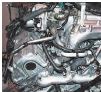
محل نصب EGR روی موتور خودرو
