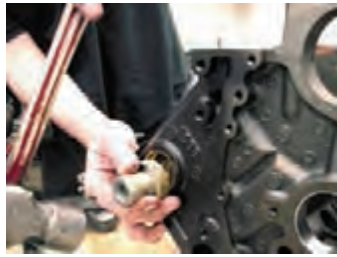
ابزار مخصوص و روش نصب پولکی
