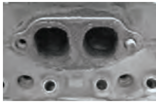
بریدن پیچ اتصال مانیفولد دود داخل سرسیلندر
