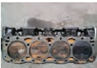
ورود مایع خنک کننده به سرسیلندر
