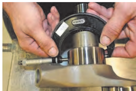
مرحله ۲: اندازه‌گیری قطر لنگ یا محور ثابت
