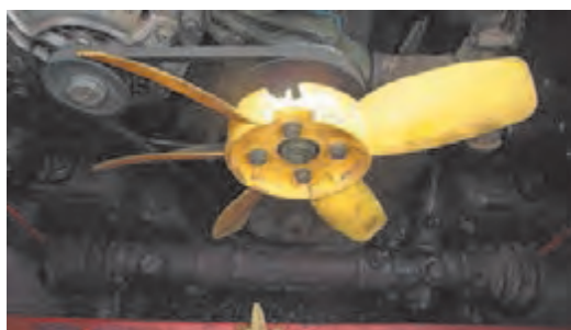
وجود شکستگی یا ترک پره‌ها
