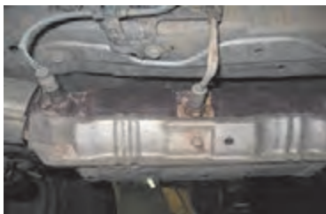
محل نصب حسگر اکسیژن روی میدل کاتالیست
