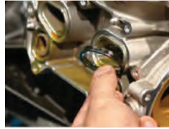
نصب اورینگ ها و واشرهای خنک کن روغن
