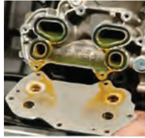
نصب درپوش خنک کن روغن
