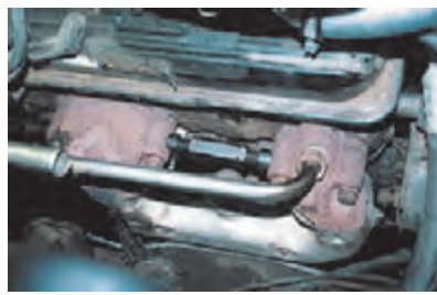
تصویر نشستی دود بین مانیفولد و سرسیلندر
