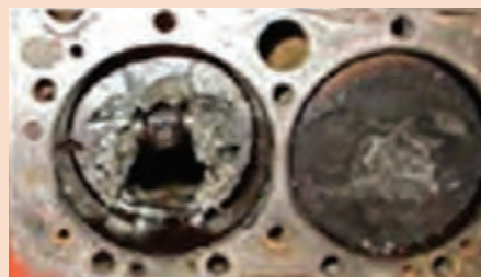
ذوب شدن پیستون
