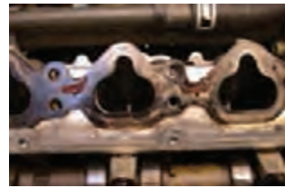
آثار نشتی مانیفولد دود روی سرسیلندر
