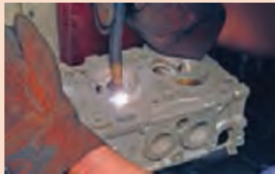
جوشکاری محل‌های خورده و یا ذوب شده سرسیلندر
