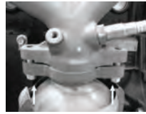
باز کردن پیچ‌های کاتالیست‌اگزوز
