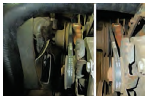
بررسی ناهم‌راستایی تسمه و میزان کشش
