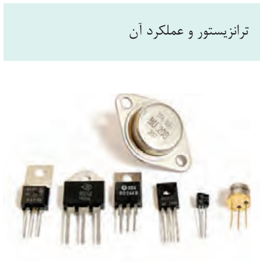
شکل ۲۲- انواع ترانزیستور و عملکرد آن
