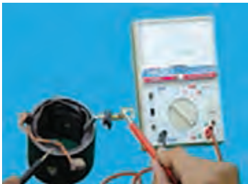
- آزمایش اتصال بدنه بالشتک ها
