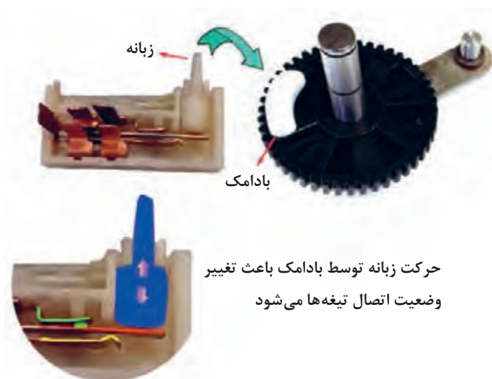
شکل ۸- کلید پارک از نوع پلاتین و بادامک
