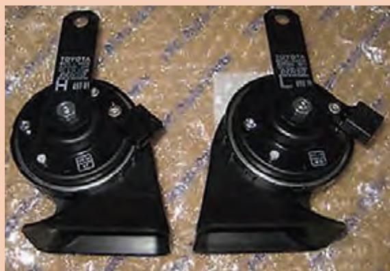
شکل ۴۸- درج L و H روی دستگاه بوق
