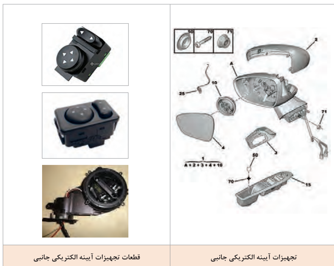
شکل ۱۱- نمونه تجهیزات مربوط به آینه جانبی الکتریکی
