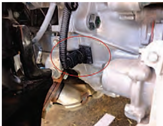
شکل ۱۸- حسگر دور موتور و محل بستن آن
