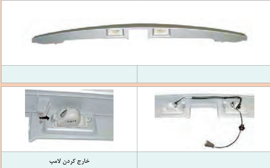
شکل ۳۵- روش باز کردن و بستن چراغ پلاک
