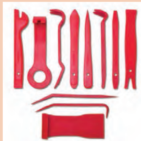
شکل ۲۱- چند نوع ابزار مخصوص تریم
