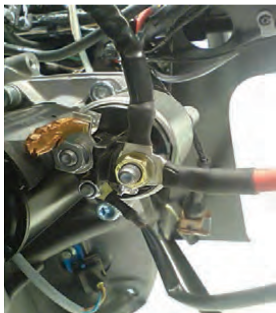
شکل ۸۹ - بررسی استحکام اتصالات پیچ و مهره‌ای مجموعه استارتر
