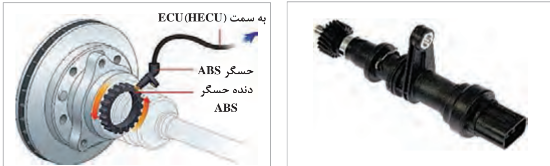
شکل ۱۶- حسگر سرعت خودرو از نوع القایی
