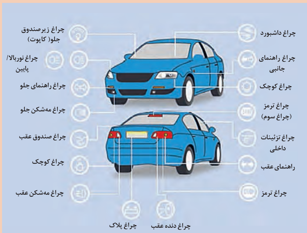
شکل ۳- محل قرارگیری چراغ‌های روشنایی خودرو
