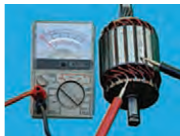
- آزمایش اتصال بدنه آرمیچر
