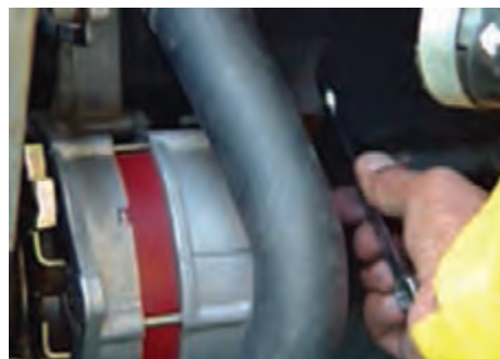
بازکردن پیچ‌های پایه آلترناتور
