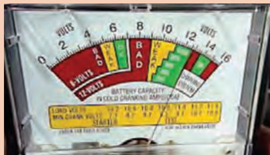
شکل ۵۱- نشان دهنده دستگاه آزمایش باتری
