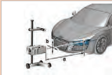
۱- ۲- تنظیم فاصله a و b براساس راهنمای کاربر دستگاه
