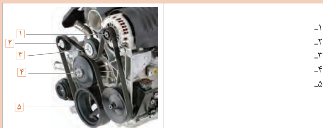
شکل ۵۶- اجزای محرک آلترناتور (روش انتقال گشتاور به پولی)
