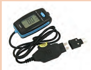
شکل ۳۲- دو نوع دستگاه تست فیوز خودرو
