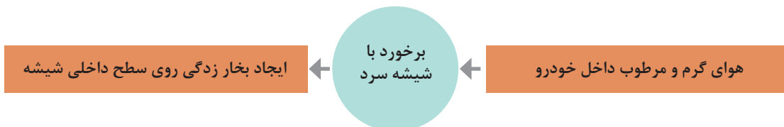
شکل ۳۲- فرایند بخار زدگی شیشه‌ها
