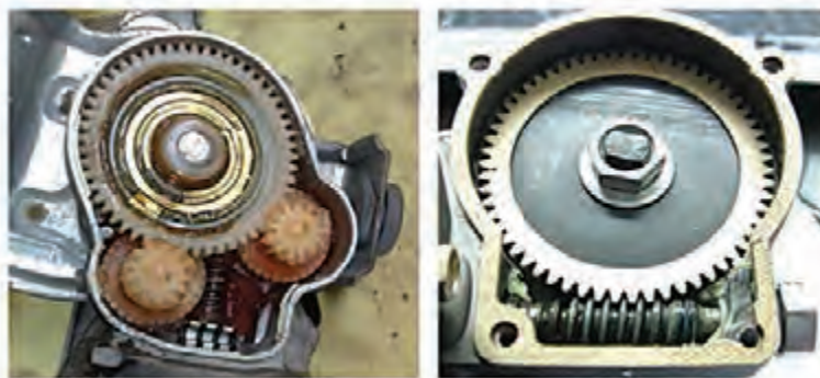
شکل ۶- دو نوع سیستم انتقال نیرو در موتور برف پاک کن
