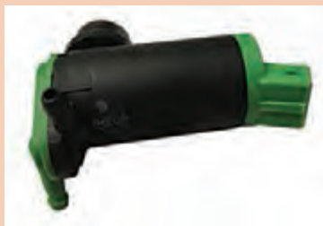
شکل ۱۷- دو نوع موتور پمپ شیشه شوی
