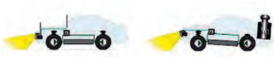
شکل ۹- دلیل نیاز به سیستم تنظیم ارتفاع چراغ
