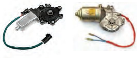
شکل ۴- دو نوع موتور شیشه بالابر
