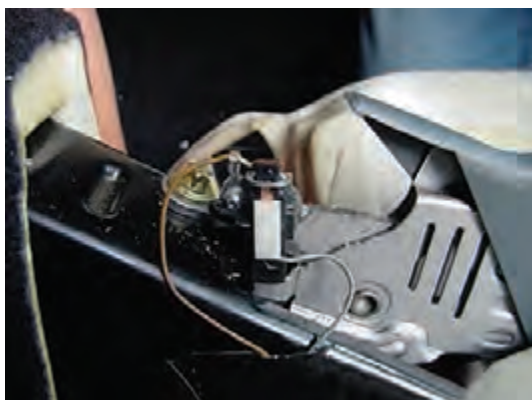
شکل ۲۴- میکروسوییچ ترمز دستی و محل بستن آن
