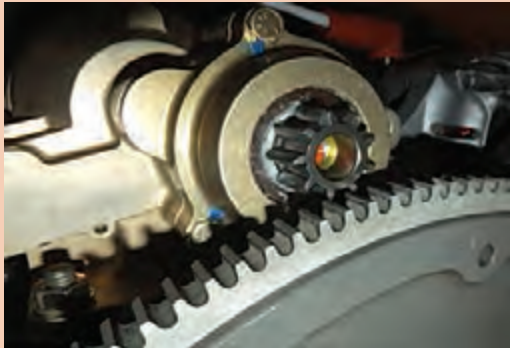
شکل ۱۰۰- ارتباط دنده فلاپیول با دنده استارتر
