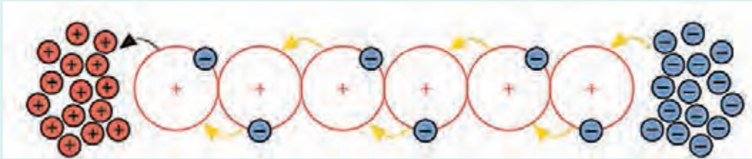
شکل ۱- حرکت الکترون‌ها در یک رسانا
