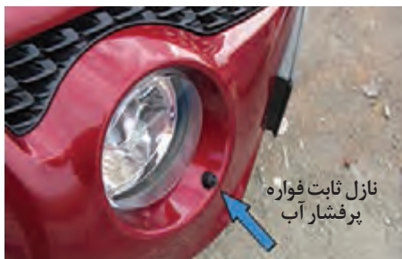
شکل ۱۹- روش های تمیز کردن چراغ
