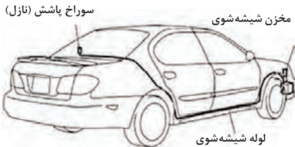
شکل ۱۶- لوله کشی آب برای شیشه شوی عقب خودرو
