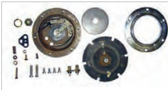
شکل ۴۵- اجزای داخلی بوق الکترومغناطیسی
