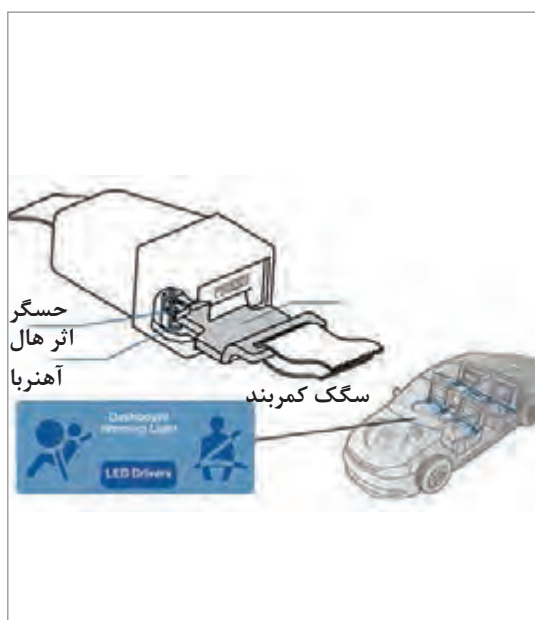
شکل ۲۲- محل قرار گرفتن میکرو سوئیچ در سگک کمر بند ایمنی و مدار آن
