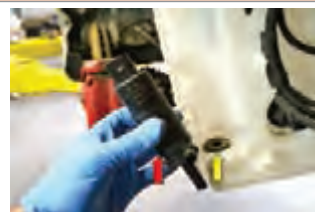
شکل ۳۰- مراحل تعویض پمپ شیشه شوی
