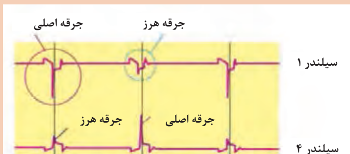
شکل ۲۴- منحنی جرقه مدار ثانویه از نوع کویل دوپل
