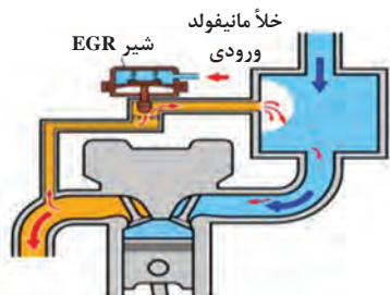
شکل ۱۹- مسیر عبور گازهای خروجی خلأی
