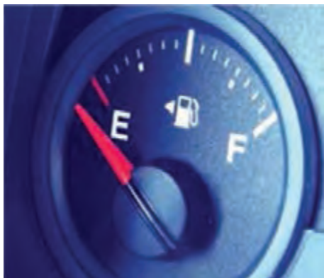
شکل ۹۱- نمایشگر سوخت آنالوگ (عقربه ای)
