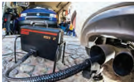
شکل ۵۴- قراردادن لوله دستگاه کنترل آلاینده‌گی درون لوله‌اگزوز
