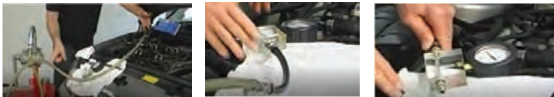
ادامه شکل ۷۶- بررسی و تعویض فیلتر سوخت
