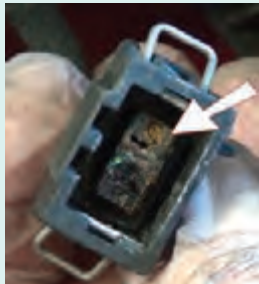
شکل ۶۲- یک نمونه سوکت معیوب
