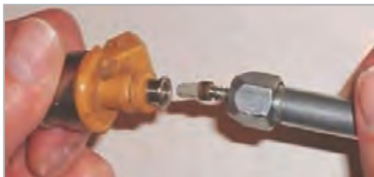
شکل ۷۹- تعویض فیلتر انژکتور
