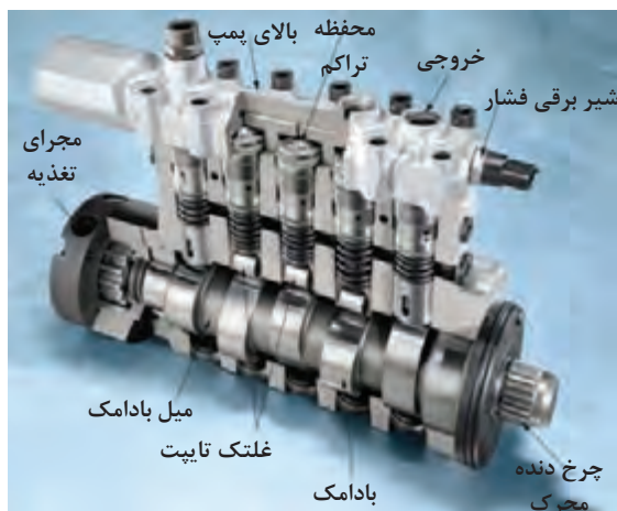
شکل ۱۰- یک نمونه پمپ انژکتور ردیفی
