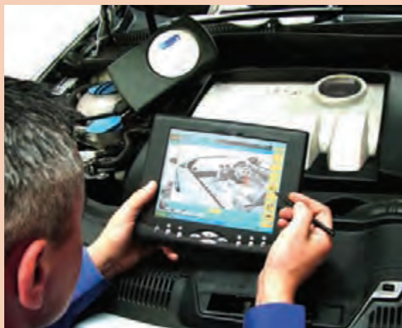
شکل ۴۴- بستن انژکتور الکترومکانیکی جدید با دستگاه عیب‌یاب
