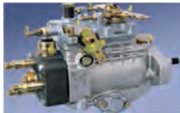
۱- پیچ تنظیم بیشترین دور ۲- پیچ تنظیم دور آرام ۳- پیچ تنظیم غنی سوزی (تمام بار) ۴- اهرم گاز ۵- اهرم استارت و خاموش کن دستی ۶- خاموش کن برقی
