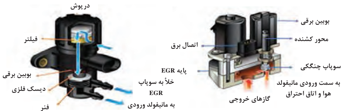
شکل ۱۶- شیر برقی EGR مدل بیرونی و داخلی
