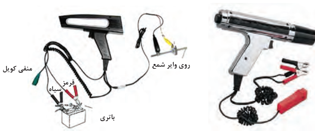
شکل ۲۰- نوعی چراغ تایمینگ و روش اتصال آن به سیم‌کشی خودرو
