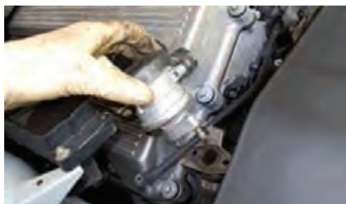
باز کردن شیر کنترل پمپ دمنده
