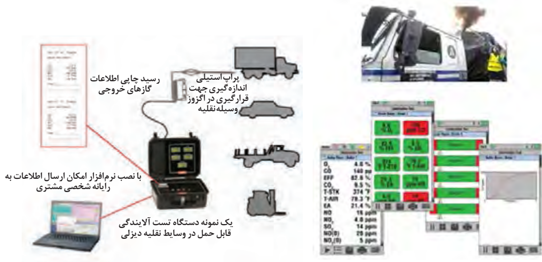
شکل ۳۲- یک نمونه دستگاه تست آلاینده‌ها در وسایط نقلیه دیزلی
