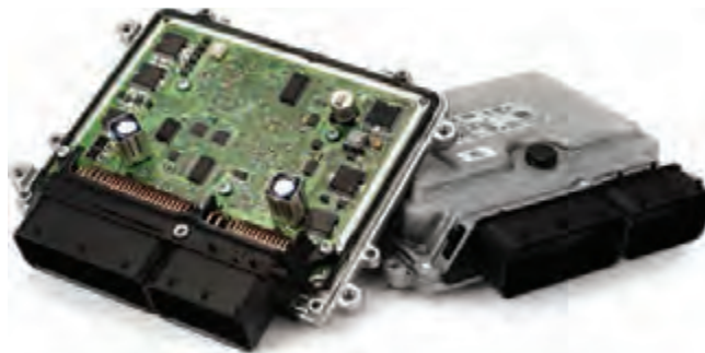
شکل ۱۹- یک نوع واحد کنترل الکترونیکی
