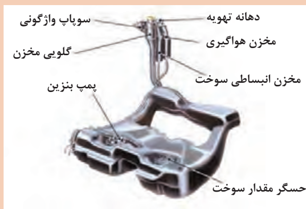
شکل ۹- شیر فشارشکن و خلأشکن
