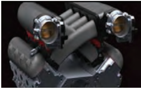
شکل ۳۶- دو نمونه مانیفولد متغیر هوای ورودی
