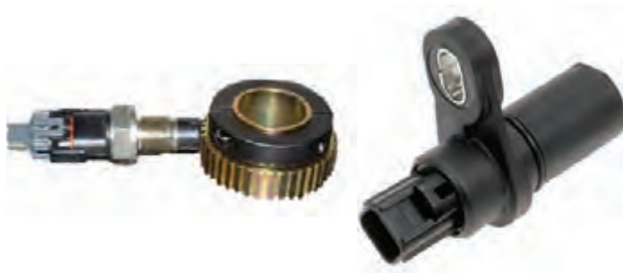
شکل ۵۸- حسگر و چرخ‌دنده بسته شده روی دیفرانسیل
