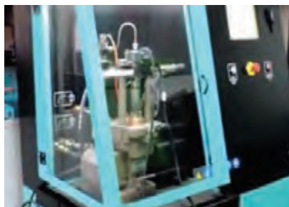
شکل ۶۱- برخی از مراحل آزمایش و تنظیم یک نوع پمپ واحد
