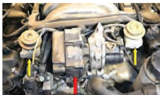
شکل ۴۸- بررسی‌های اتصالات مکانیکی، الکتریکی و خلأئی پمپ دمنده
