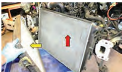
جداکردن رادیاتور خنک کن با هوا
