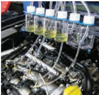
شکل ۴۰- تست اندازه گیری مقدار سوخت برگشتی انژکتورها
