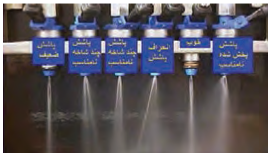
شکل ۷۷- انواع احتمالی پاشش سوخت در انژکتور
