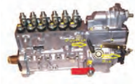
شکل ۴۴- اهرم‌های گاز و خاموش کن در پمپ ردیفی بوش مدل P
