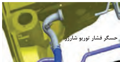
شکل ۲۸- موقعیت حسگر فشار توربو شارژر
