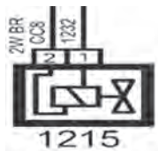
شکل ۵- نماد سوپاپ برقی کنیستر در نقشه ها
