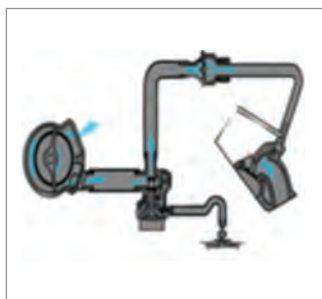
پمپ تزریق ثانویه اسماگ
