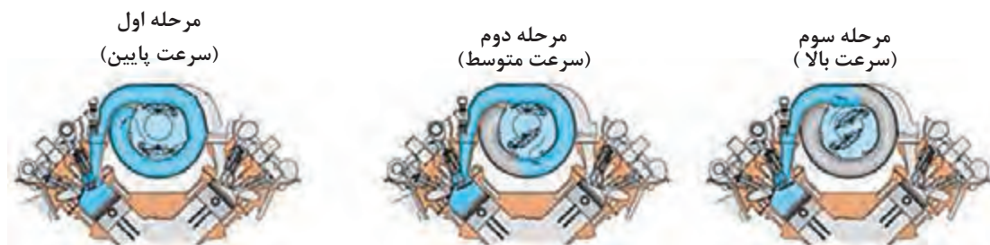
شکل ۳۷- عملکرد سیستم مانیفولد متغیر
