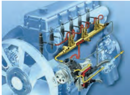
شکل ۴- اجزای سیستم سوخت رسانی ریل مشترک
