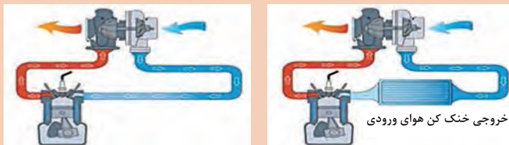
شکل ۳۱- مقایسه مسیر عبور هوا در سیستم مجهز به خنک کن هوای ورودی و بدون آن
