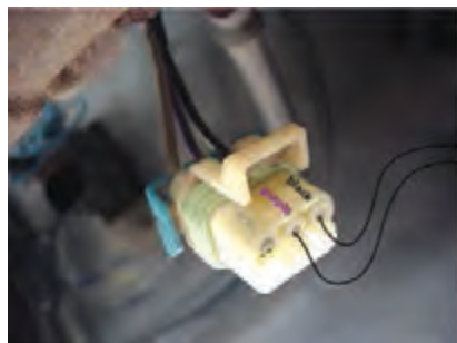
شکل ۳۵- آزمایش مقاومت داخلی قطعه
