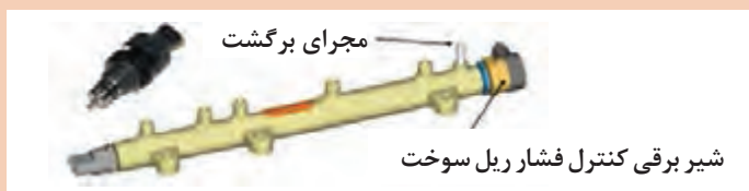
شکل ۱۶- سوپاپ کنترل فشار الکتریکی در تزریق ریل مشترک
