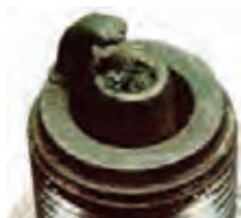
شکل ۳- آسیب به شمع بر اثر خودسوزی
