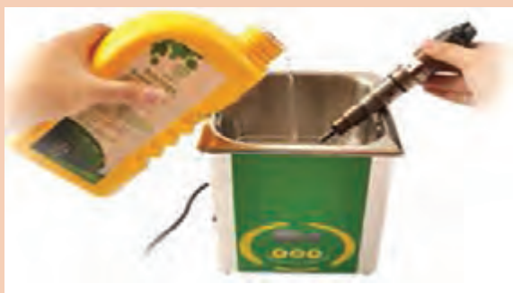
شکل ۸۳- تمیز کردن سوراخ انژکتور با دستگاه اولتراسونیک
