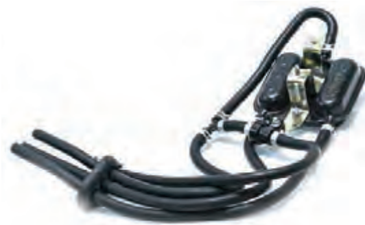
شکل ۶- ساختمان سیستم حباب گیر بنزین
