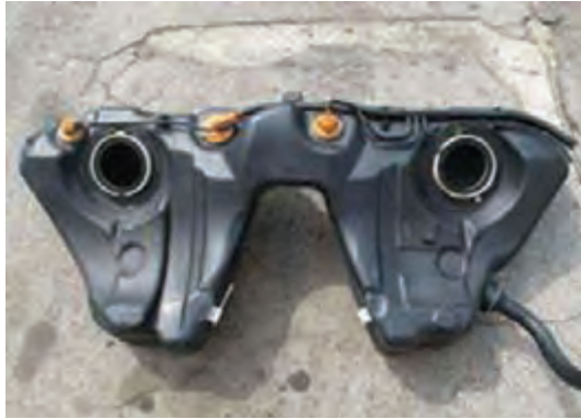
شکل ۷- مخزن سوخت با سوپاپ واژگونی
