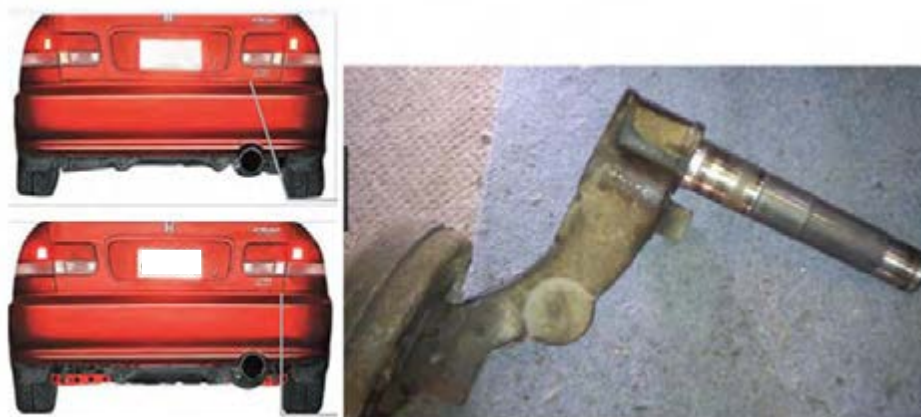
شکل ۴۳- خرابی بوش‌ها و تأثیر آن روی چرخ
