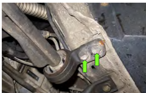
گشتاور سنجی اتصالات پیچ و مهره ای
