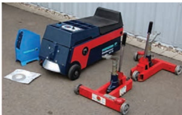
شکل ۲۴- نوعی دستگاه بالانس درجای چرخ
