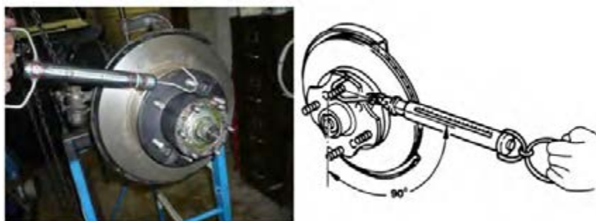
شکل ۱۸- بررسی توپی و بلبرینگ یا رولبرینگ
