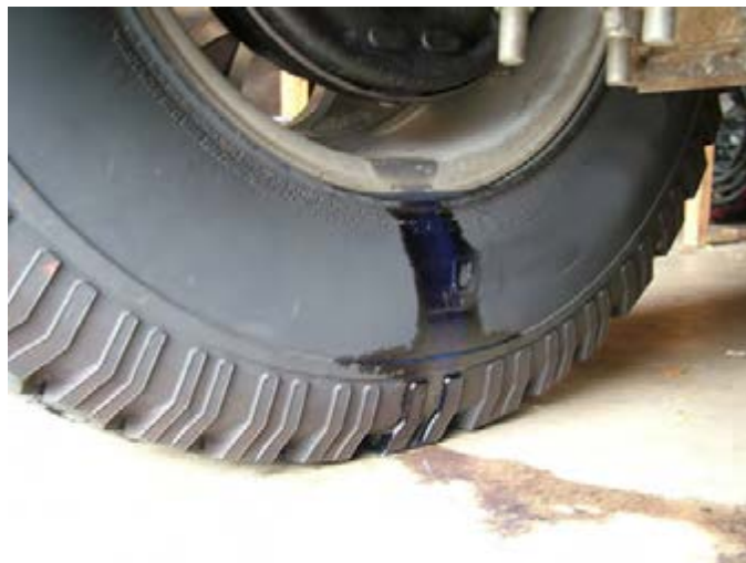
شکل ۴۱- وجود مایع اطراف چرخ عقب
