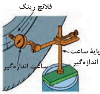
شکل ۱۸- بررسی تغییر شکل تایر و رینگ
